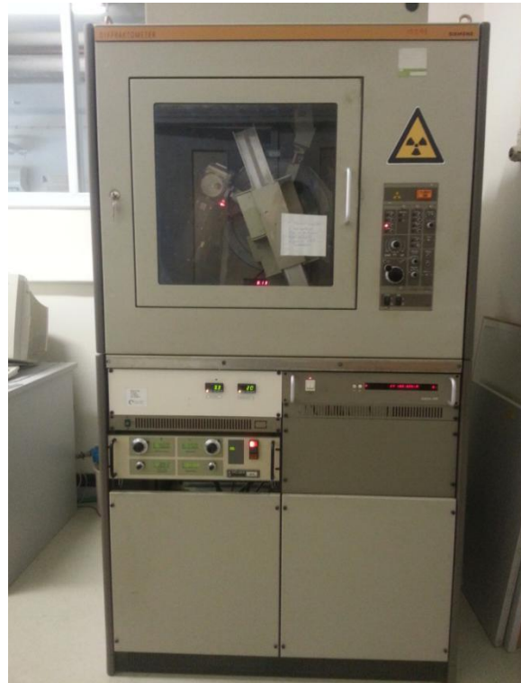
Σχήμα 2.2 Μηχάνημα περίθλασης ακτίνων-X
