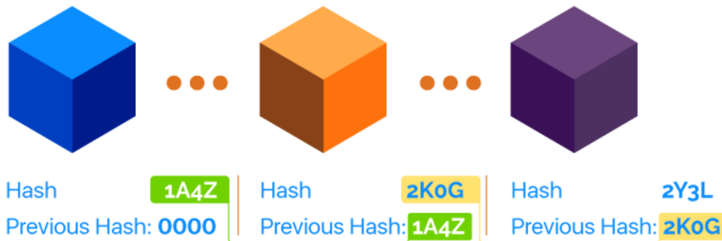
Εικόνα 4 : Παράδειγμα μιας αλυσίδας Blockchain με τα μπλοκ να συνδέονται μεταξύ τους με χρονολογική σειρά
