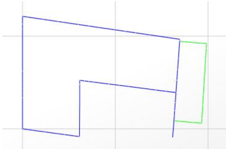
Εικ. 4.2 : Χρωματική απεικόνιση των παχών της τοιχοποιίας – Μπλε χρώμα : t_w=0.55 m, Πράσινο χρώμα : t_w=0.30 m
