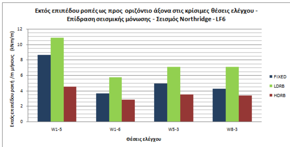
Εικ. 10.3.8 : Επίδραση της σεισμικής μόνωσης βάσης στις μέγιστες εκτός επιπέδου ροπές περί οριζόντιο άξονα των θέσεων ελέγχου - Σεισμός Northridge, LF6.
