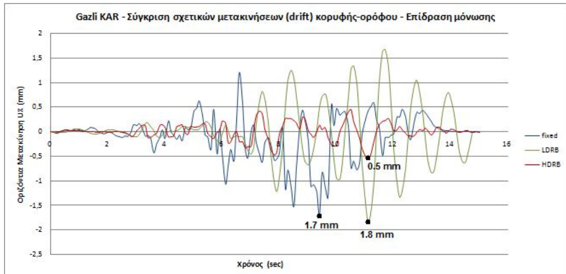
Εικ. 11.2.5 : Χρονοϊστορίες σχετικών μετακινήσεων κορυφής ως προς το σύστημα μόνωσης – Επίδραση μόνωσης. Σεισμός Gazli, KAR.
