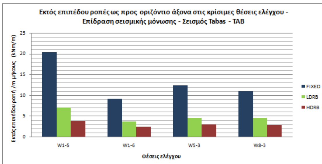
Εικ. 12.2.8 : Επίδραση της σεισμικής μόνωσης βάσης στις μέγιστες εκτός επιπέδου ροπές περι οριζόντιο άξονα των θέσεων ελέγχου - Σεισμός Tabas, TAB.
