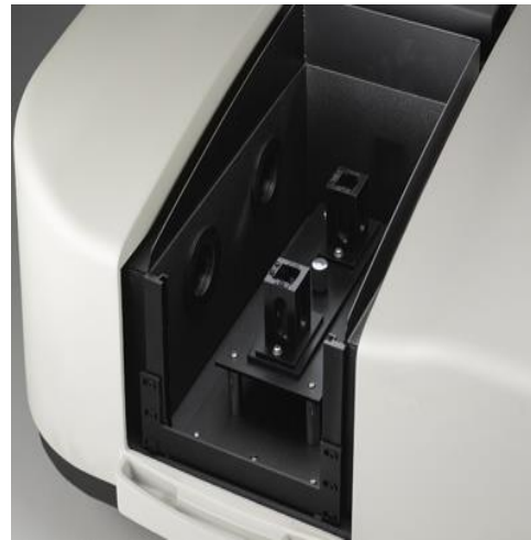
Εικόνα 2.7: Εσωτερικό φωτομέτρου- δειγματοφορέας
