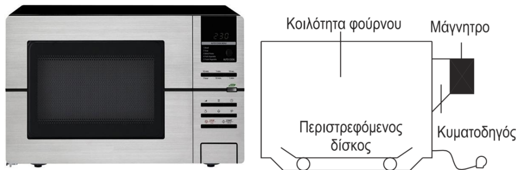
Εικόνα 3.3: Οικιακός φούρνος μικροκυμάτων και Εξαρτήματα φούρνου μικροκυμάτων
