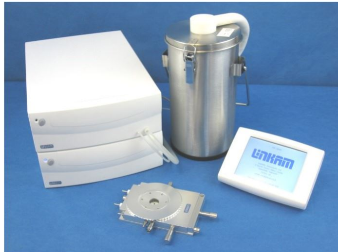
Σχήμα 4.2: Πειραματικός εξοπλισμός που πλαισιώνει την κυψελίδα: σύστημα ψύξης/θέρμανσης και ελέγχου θερμοκρασίας, και δοχείο Dewar για την αποθήκευση υγρού αζώτου (Πηγή: [30])
