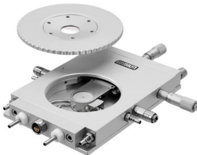
Σχήμα 4.1: Η κυψελίδα εντός της οποίας φυλάγαμε, θερμαίναμε και ψύχαμε το δείγμα, και αναπτύσσαμε το περιβάλλον αζώτου ή ηλίου. (Πηγή: www.linkam.co.uk/thms600 , 22 Ιουνίου 2020)
