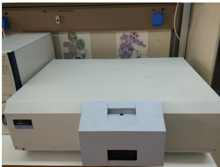
Εικόνα 21: Φασματόμετρο εκπομπής; Perkin – Elmer LS 45 Luminescence Spectrometer.
