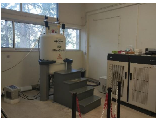
Εικόνα 14: Όργανο NMR: Bruker Avance 500 MHz spectrometer operating at 500 MHz ( ^1\text{H} ) and 125 MHz ( ^{13}\text{C} ).
