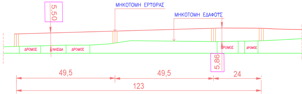
Σχήμα 3.10: Μηκοτομή εδάφους και ερυθράς για τους φορείς 1 και 2
