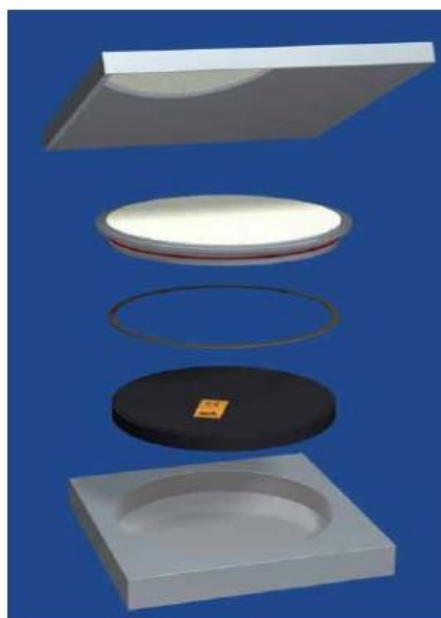
Εικόνα 10.2: Κύρια μέρη ενός εφεδράνου τύπου rot bearing
