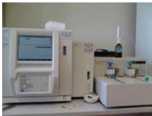
Εικόνα 12: Συσκευή μέτρησης ολικού οργανικού άνθρακα TOC
