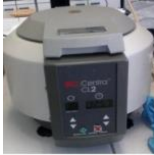
Εικόνα 19: Συσκευή φυγοκέντρησης IEC/Centra CL2
