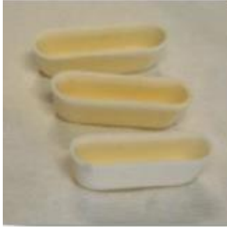
Εικόνα 13: Κάψες πορσελάνης που χρησιμοποιούνται στην συσκευή μέτρησης TOC.
