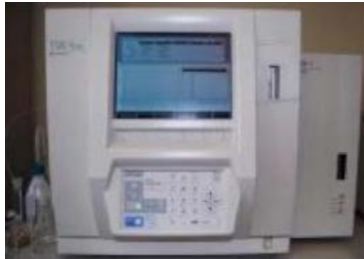
Εικόνα 14: Φούρνος (Solid Sample Module SSM 5000A)
