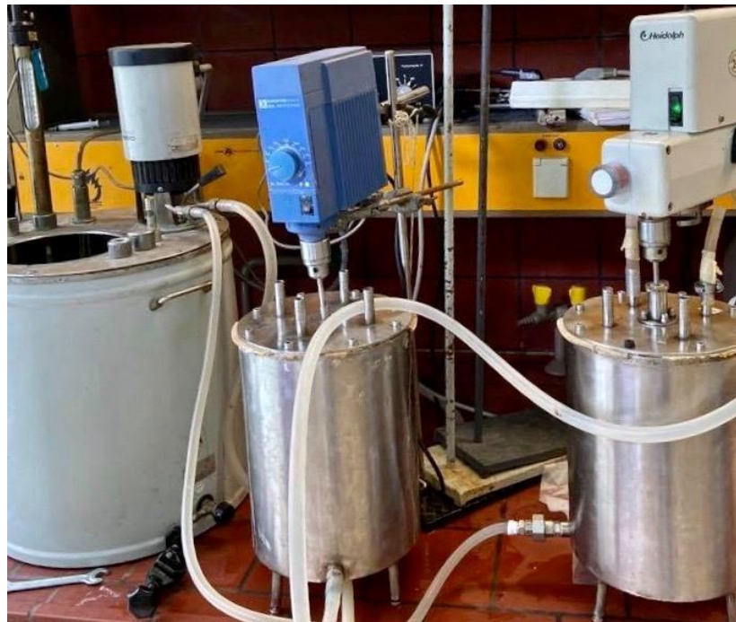
Εικόνα 4: Πειραματική διάταξη για την προετοιμασία των δειγμάτων SCG και BSG.
