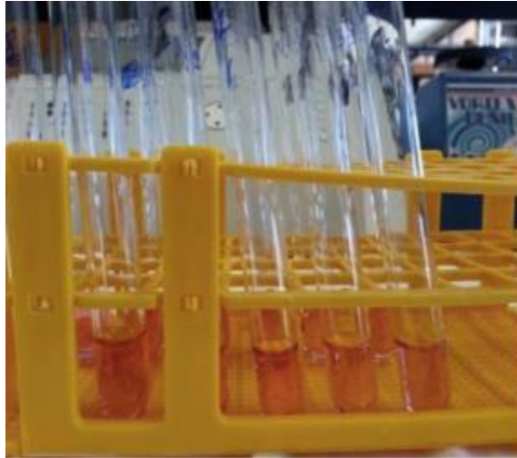
Εικόνα 16: Προσδιορισμός ελεύθερης γλυκόζης με τη μέθοδο GOD/PAP
