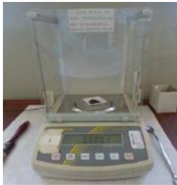
Εικόνα 8: Αναλυτικός ζυγός ακριβείας 4 δεκαδικών ψηφίων.
