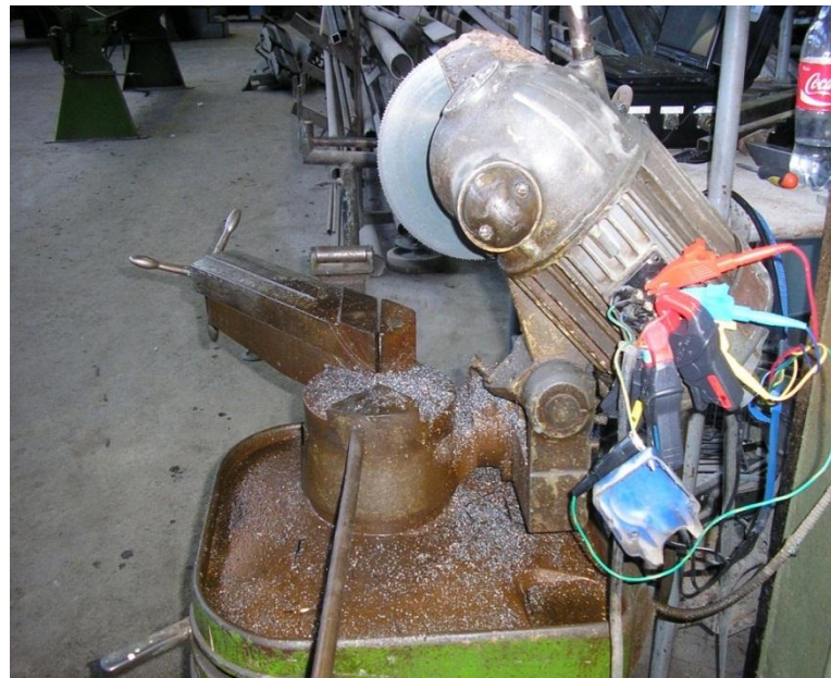
Σήμα 5.17: Σύνδεση αισθητηρίων στον τροχό κοπής.
