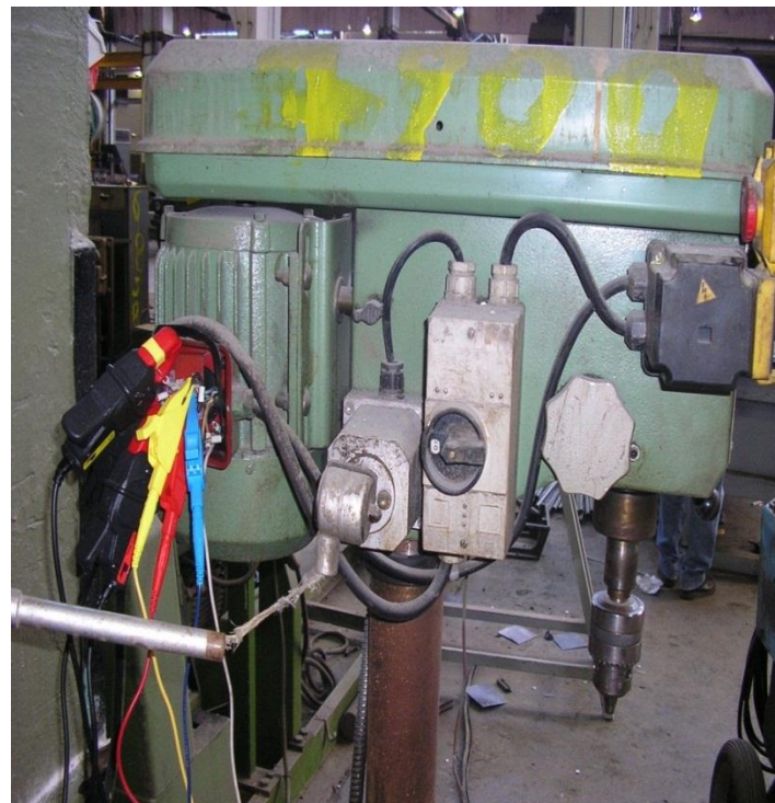
Σχήμα 5.23: Σύνδεση αισθητηρίων καταγραφής ρεύματος.
