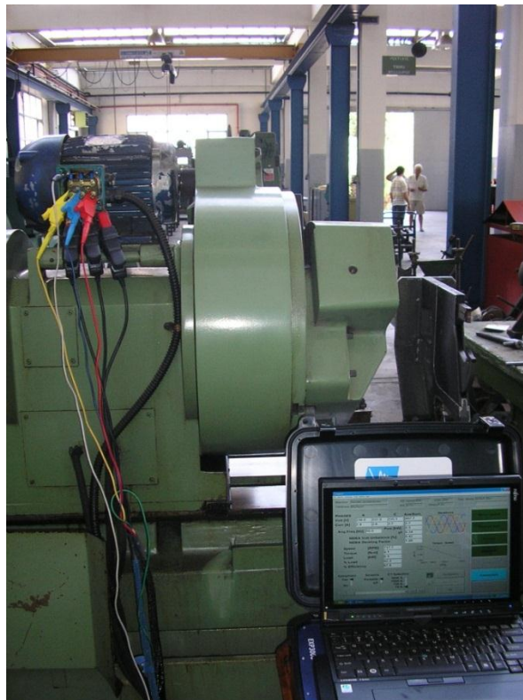
Σχήμα 5.52: Καταγραφή ρεύματος στη μηχανή ρεκτιφιέ στροφαλοφόρου άξονα.
