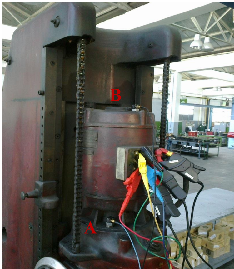
Σχήμα 5.63: Αισθητήρια καταγραφής ρεύματος και κραδασμών.
