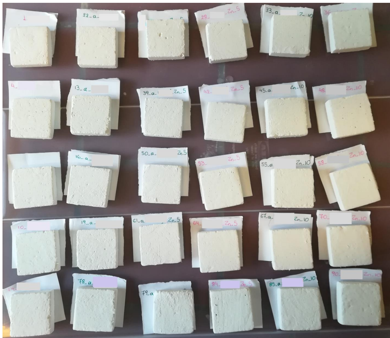
Εικόνα VII : Δοκίμια τσιμέντου διαστάσεων (4x4x1) cm επικαλυμμένα με τους τρόπους βαφής που παρουσιάζονται στον Πίνακα I.
