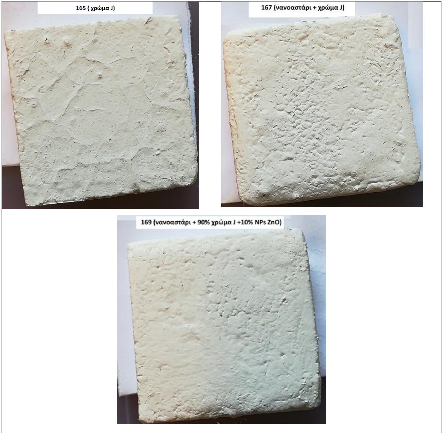
Εικόνα XI: Διαβρωμένες επιφάνειες δοκίμιων του χρώματος J.
