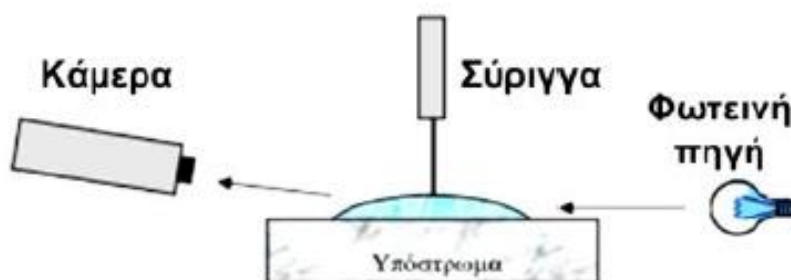
Εικόνα VIII: :Διάταξη Φωτογράφισης της γωνίας επαφής.
