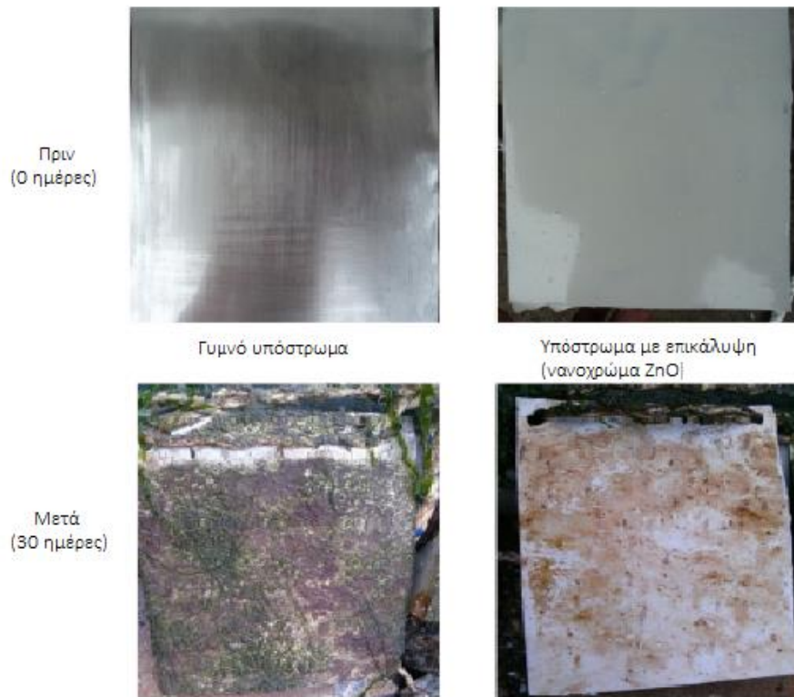
Εικόνα 1 : In situ δοκιμές ρύπανσης μεταλλικής επιφάνειας βυθισμένης σε λιμνάζον νερό (που επικοινωνεί με θαλάσσιο) για 30 ημέρες [13] .
