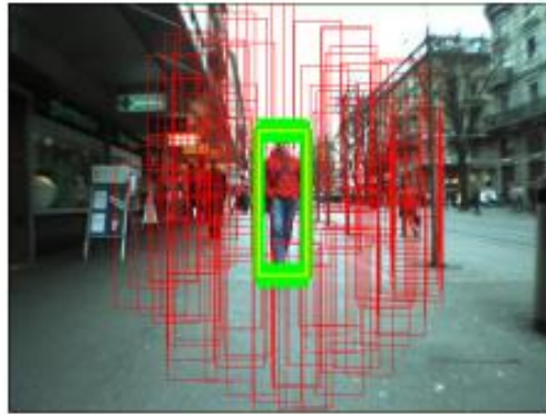
Εικόνα 3.8 : Οπτικοποίηση θετικών (πράσινα κουτιά) και αρνητικών (κόκκινα κουτιά) δειγμάτων που δημιουργεί ο αλγόριθμος oICF [13]. Με κίτρινο χρώμα εμφανίζεται η εκτιμώμενη θέση του στόχου.
