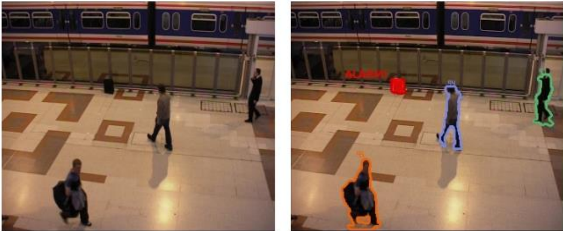
Εικόνα 1.2 : Παράδειγμα αλγορίθμου παρακολούθησης ενός πλήθους ανθρώπων που χρησιμοποιείται για τον εντοπισμό και την παρακολούθηση εγκαταλελειμμένων και πιθανόν επικίνδυνων αντικειμένων.
