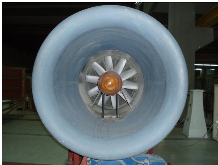
Εικ. Συμπιεστής αεροδυναμικής σήραγγας αξονικού τύπου
