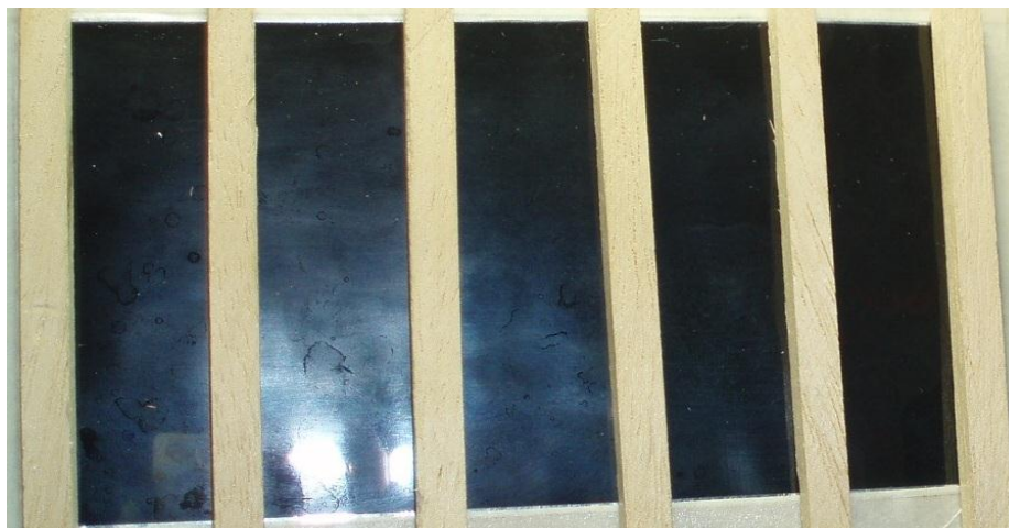
Εικ. Θερμαινόμενη πλάκα επικαλυμμένη με φύλλο υγρών κρυστάλλων και διάταξη ξύλινων εμποδίων
