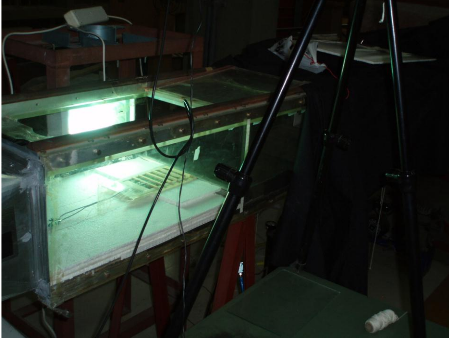
Εικ. Θέση καταγραφής, τοιχώματα από πλεξιγκλας και πηγή φωτός
