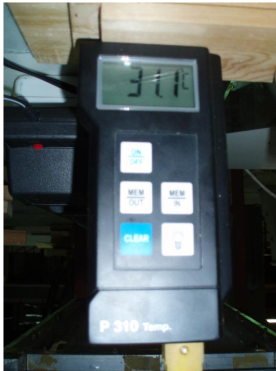
Εικ. Διάταξη μέτρησης θερμοκρασίας με probe συνδεδεμένο στο μέσο της πλάκας
