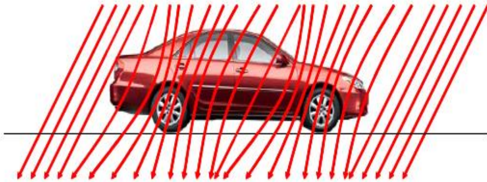
Σχήμα 21: Διαταραχή των Μαγνητικών γραμμών του γήινου πεδίου από την παρουσία οχήματος [5].
