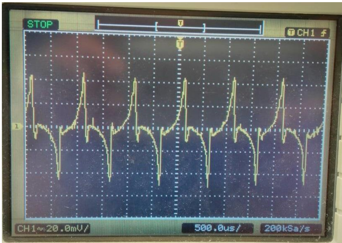
Σχήμα 41: Σήμα εξόδου αισθητήρα με πηνίο 3cm.
