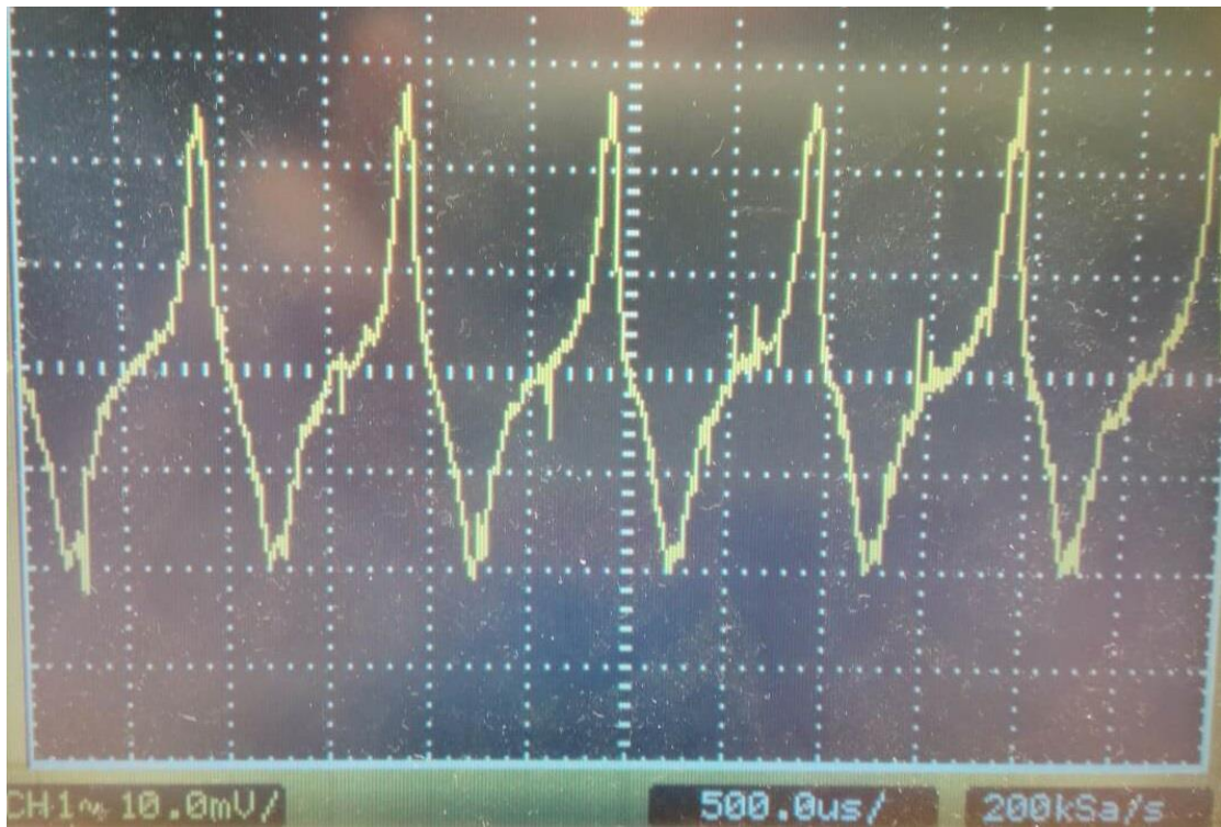
Σχήμα 40: Σήμα εξόδου αισθητήρα με πηνίο 2cm.
