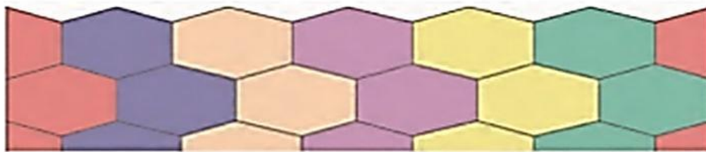
Σχήμα 2.11.3 α: Διάταξη εξαγωνικού συστήματος, (ITA-WG2,2000)
