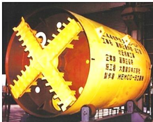
Σχήμα 2.15.6.1 : Ασπίδα εδαφικής πίεσης για την ευστάθεια μετώπου, Katsushika Ward, Tokyo, 1976 (jsce,2001)
