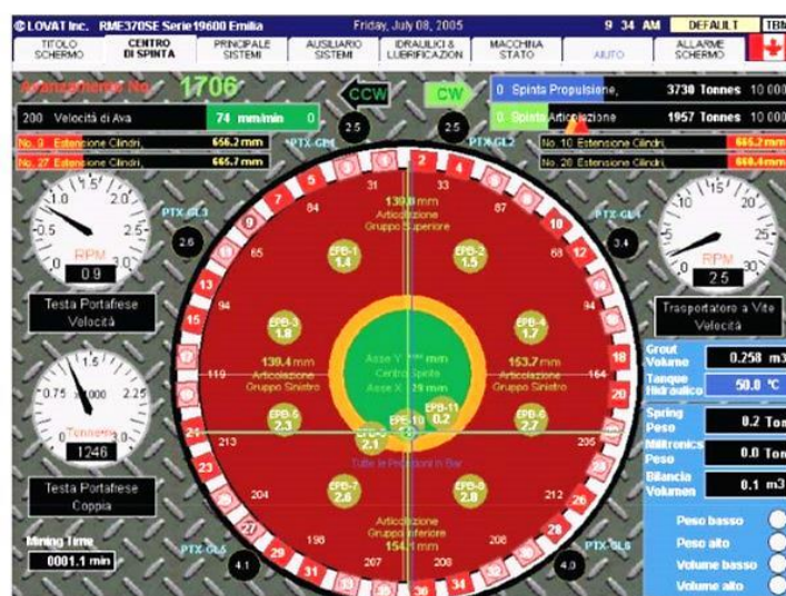
Σχήμα 2.15.6.2 δ:Η οθόνη ελέγχου σε EPB μηχανή
