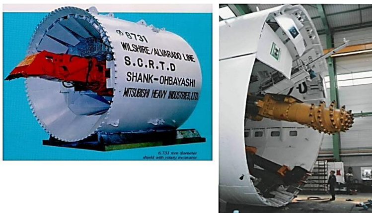
Σχήμα 2.15.2: Ασπίδες SM-T2, ε βραχίονα εκσκαφέα και βραχίονα φρέζας διαμέτρου 9495mm που χρησιμοποιήθηκε για την διάνοιξη 1911m στη γραμμή 2 του μετρό της Αθήνας, (Σοφιανός Α.Ι, 2018)
