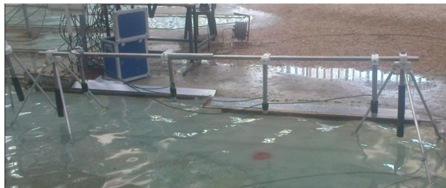
Εικόνα 2.4 : Διάταξη απορροφητικού μετώπου
