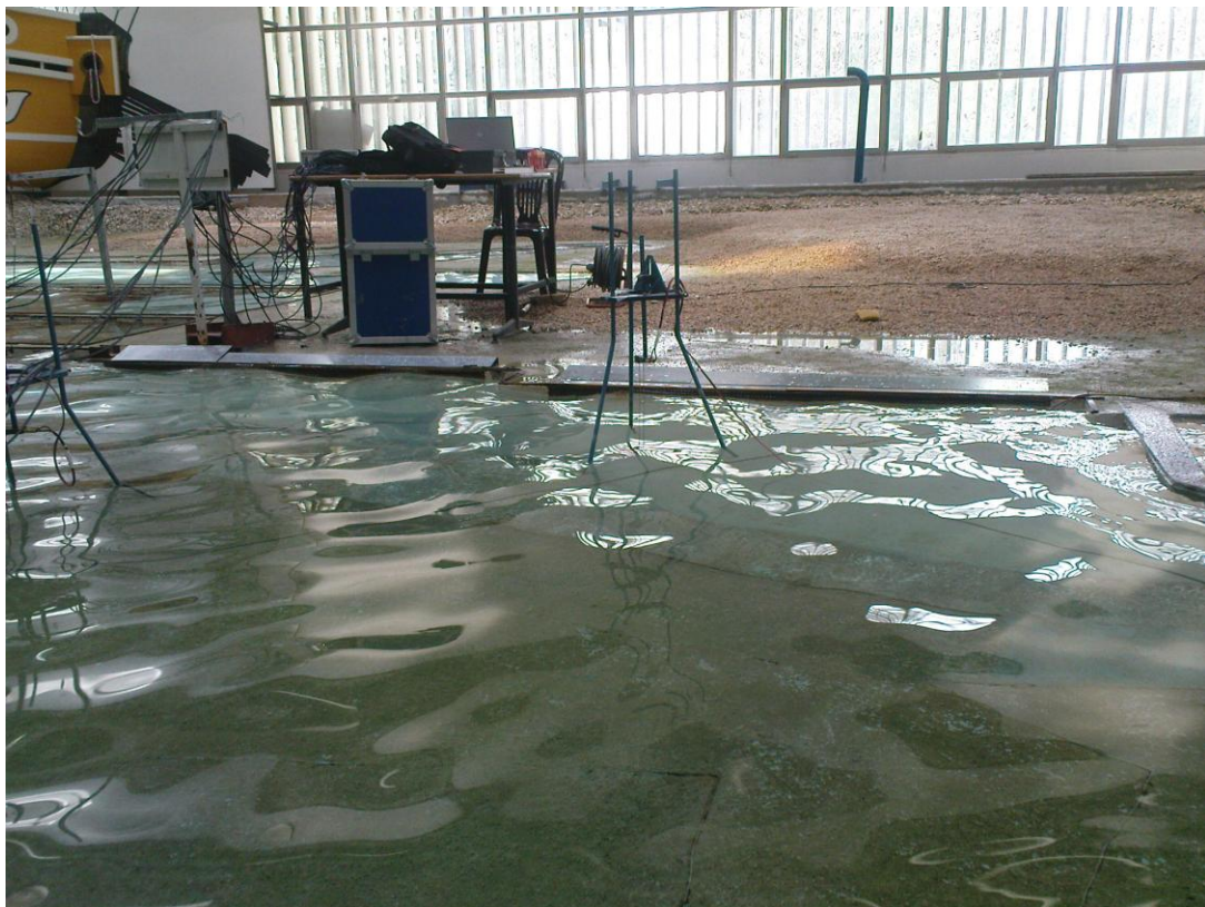
Εικόνα 6.4 : Όψη απορροφητικού μετώπου κατά την διάρκεια των μετρήσεων
