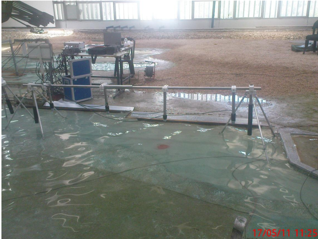
Εικόνα 6.7 : 3 η Υποπεριοχή ηχοβολιστικών μετρητών με απορροφητικό μέτωπο
