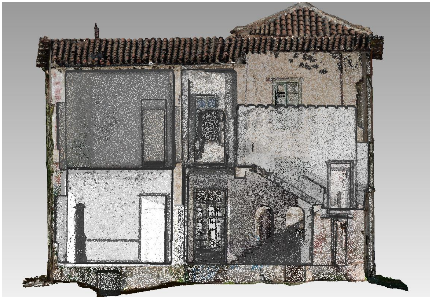
Εικόνα 61: Τομή τρισδιάστατου μοντέλου της Βίλλας Κλωναρίδη με υφή, όπου διακρίνονται οι χώροι στο εσωτερικό, καθώς και χαρακτηριστικές λεπτομέρειες όπως η κύρια σκάλα του κτηρίου
