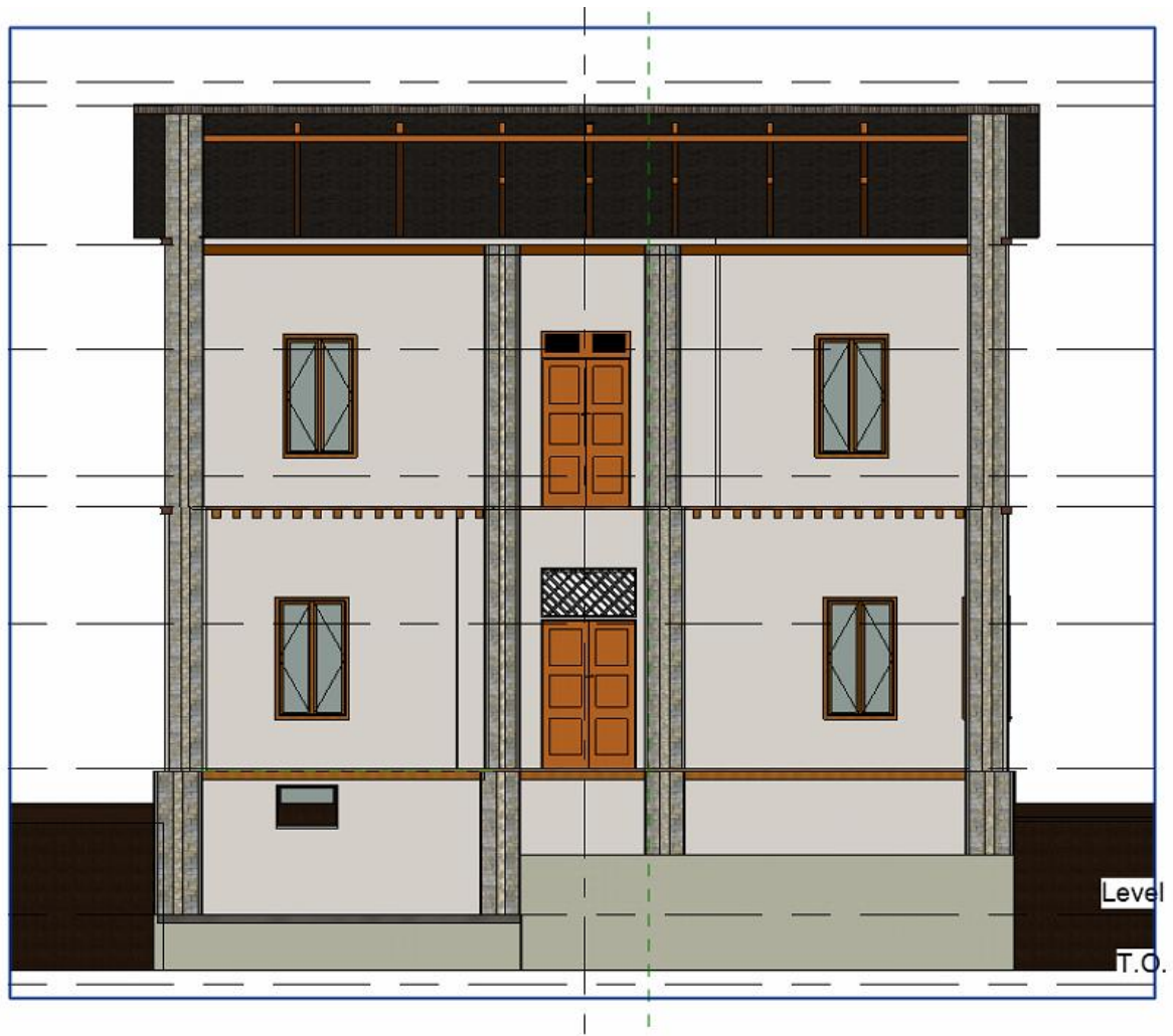
Εικόνα 76: Κατά πλάτος τομή της Βίλλας Κλωναρίδη όπου πληροφορίες που σχετίζονται με τον τρόπο δόμησης των τοιχοποιιών είναι εμφανή
