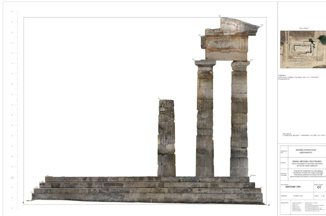
Εικόνα 40: Ανατολική όψη του ναού. Εικονιστικό προϊόν γεωμετρικής τεκμηρίωσης 223
