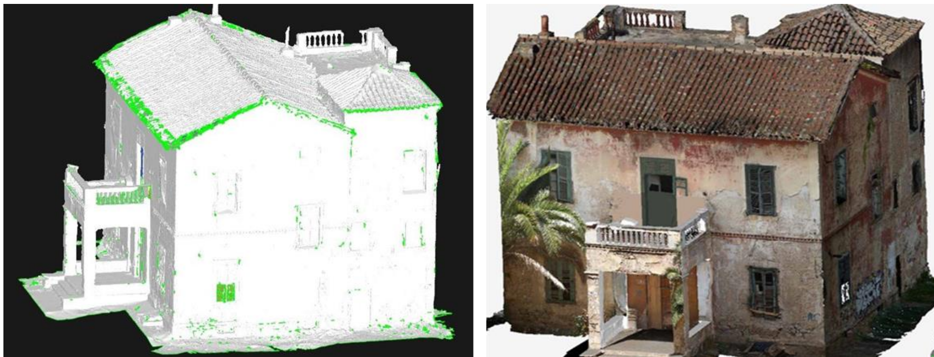
Εικόνα 59: Τρισδιάστατο μοντέλο Βίλλας Κλωναρίδη με τη μορφή τριγώνων (α) και τρισδιάστατο μοντέλο με υφή (β)
