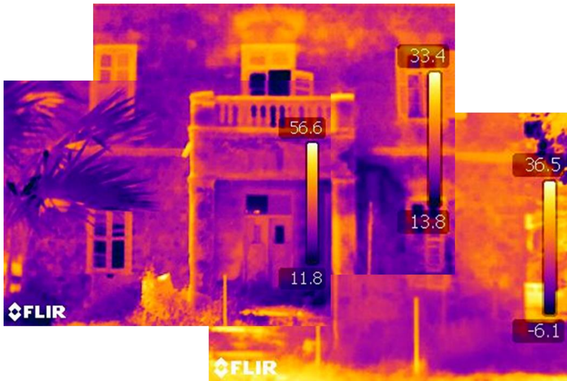
Εικόνα 65: Θερμογραφία Υπερύθρου στην Ανατολική όψη της Βίλλας Κλωναρίδη
