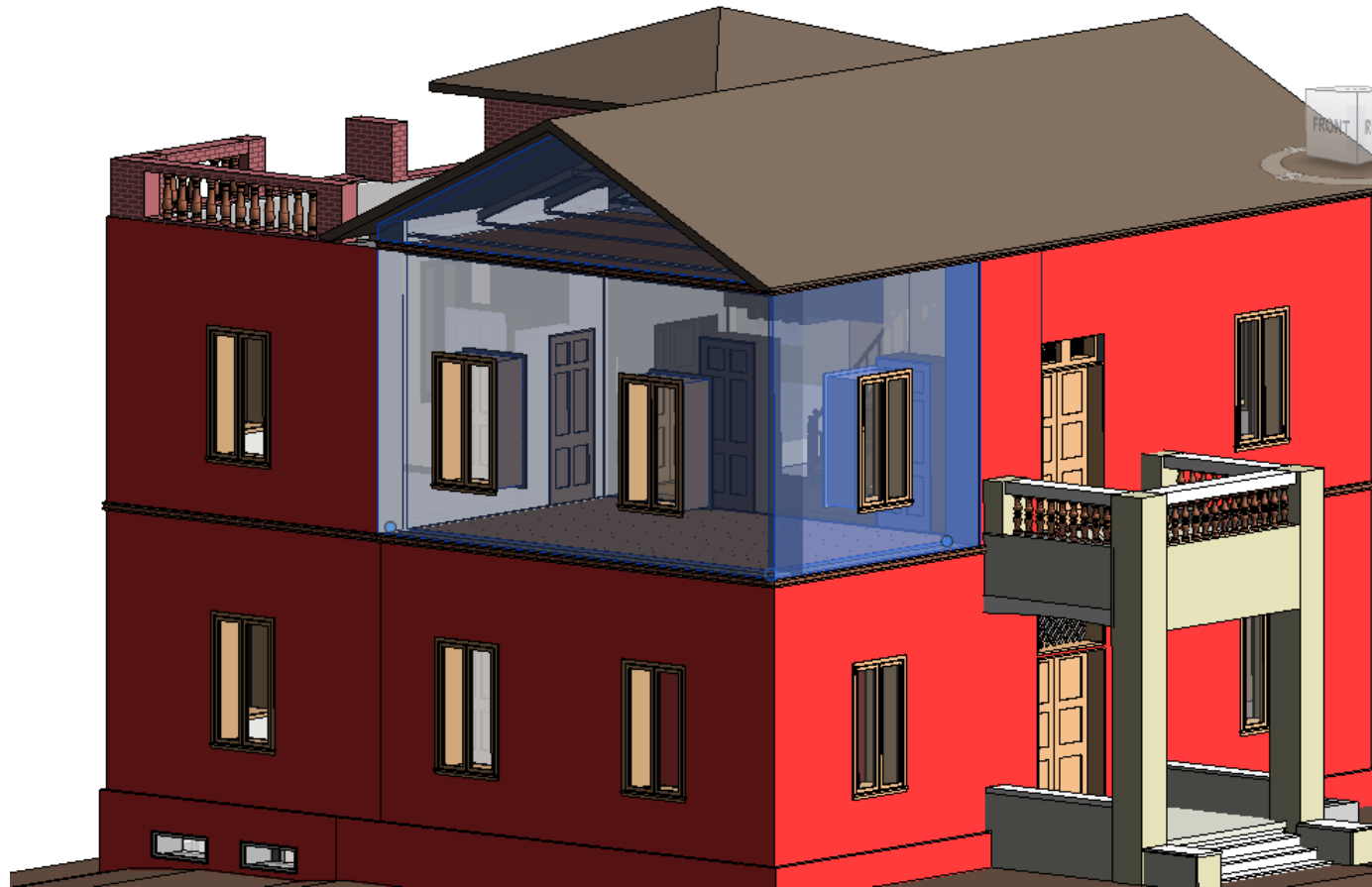
Εικόνα 78: Τρισδιάστατο μοντέλο BIM με ενσωματωμένες πληροφορίες σχετικά με τις εσωτερικές σκάλες, τις εσωτερικές πόρτες, τα δάπεδα κλπ.
