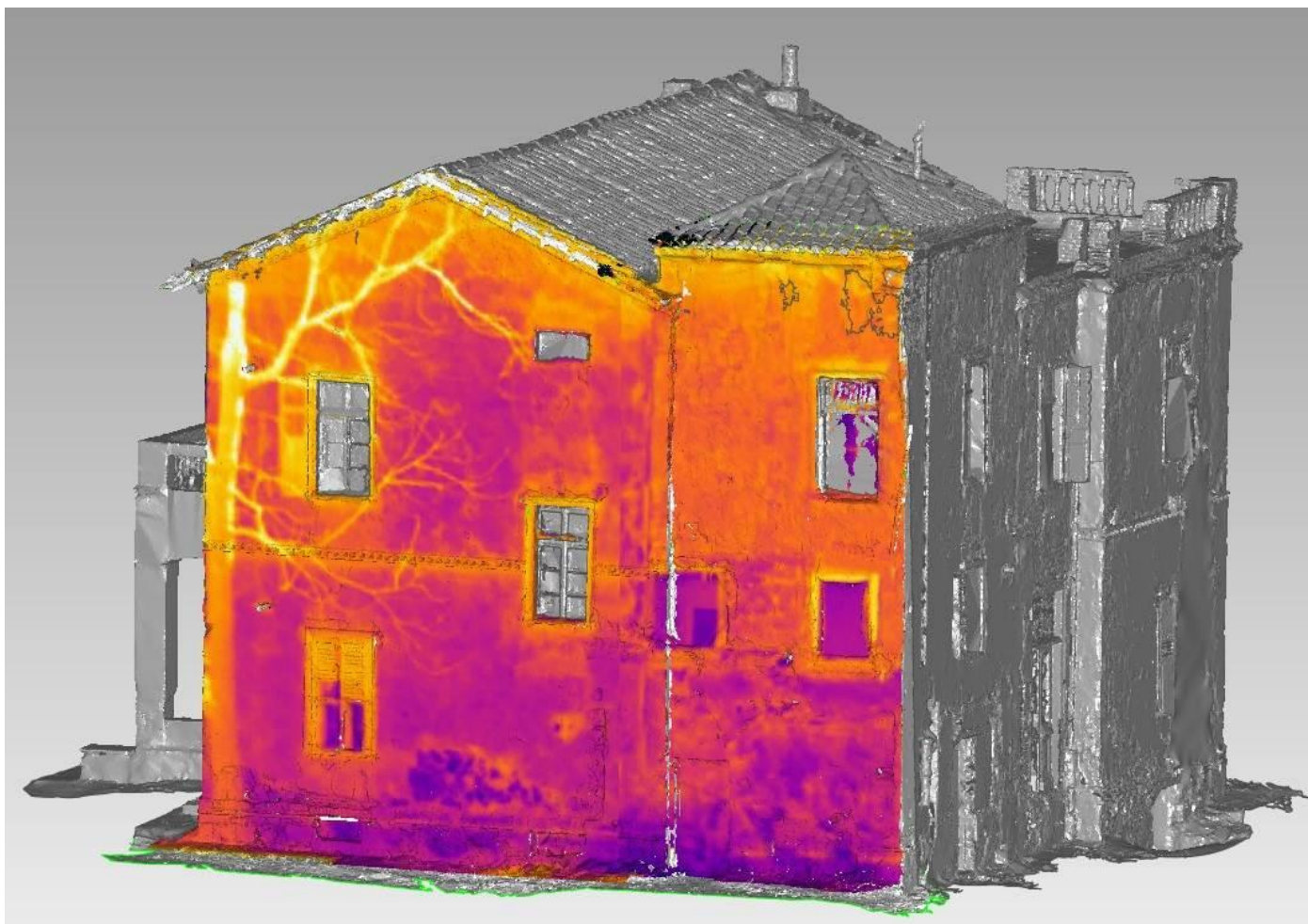
Εικόνα 68: Διαχείριση αποτελεσμάτων θερμογραφίας υπερύθρου ως υφή στο τρισδιάστατο μοντέλο και πιο συγκεκριμένα στη βόρεια όψη του ιστορικού κτηρίου
