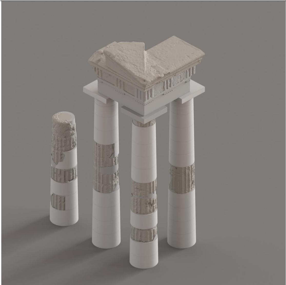
Εικόνα 46: Βορειοανατολική άποψη από το τρισδιάστατο μοντέλο της πρότασης αποκατάστασης των κίωνων του Ναού του Πυθίου Απόλλωνα 223
