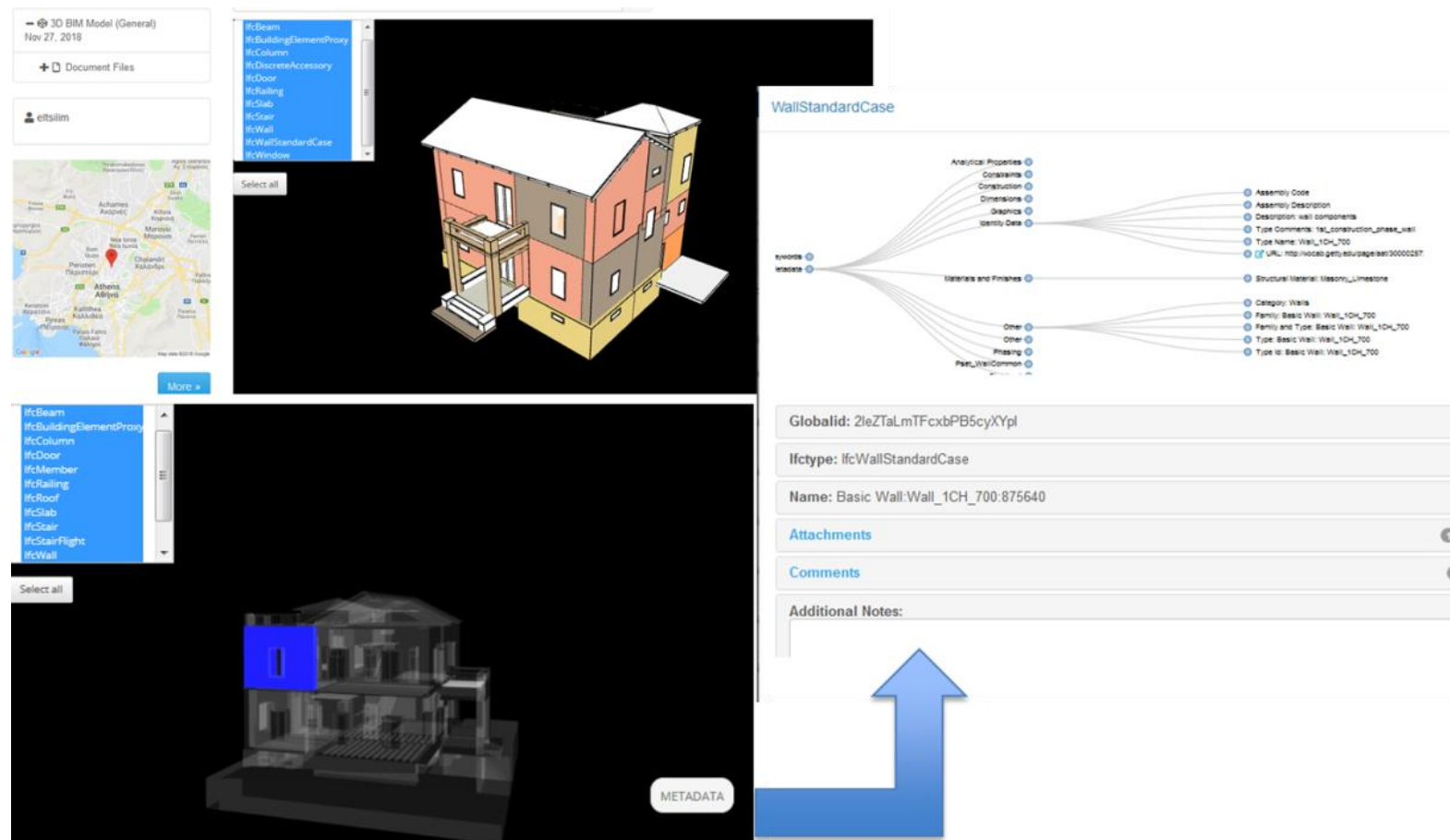
Εικόνα 125: Διαχείριση τρισδιάστατου μοντέλου μέσα στο ψηφιακό περιβάλλον της πλατφόρμας, όπου διακρίνονται οι οντολογίες και τα επίπεδα σημασιολογικών εννοιών που είναι ενσωματωμένα σε κάθε δομικό στοιχείο του ιστορικού κτηρίου 248
