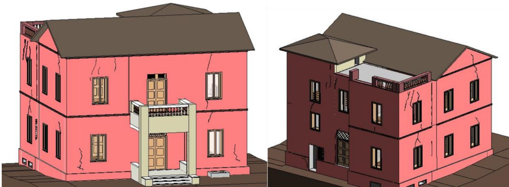
Εικόνα 80: Τρισδιάστατο μοντέλο HBIM με ενσωματωμένα δεδομένα φθοράς (ρωγμές) που προέρχονται από τη 2D πλατφόρμα ΓΣΠ 236
