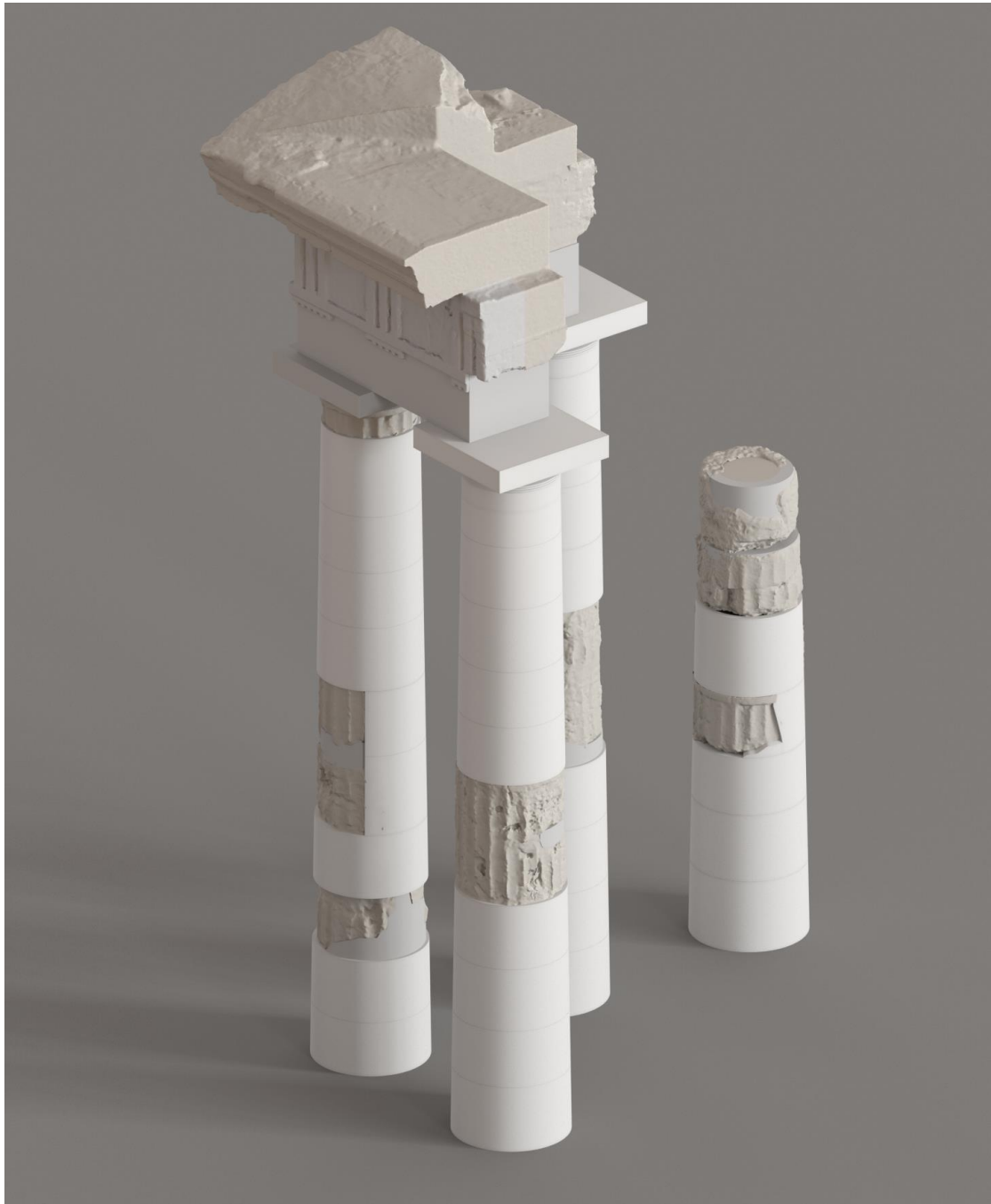
Εικόνα 45: Βορειοδυτική άποψη από το τρισδιάστατο μοντέλο της πρότασης αποκατάστασης των κίωνων του Ναού του Πυθίου Απόλλωνα, με διατήρηση του Αρχαίου Λίθου (μπεζ χρώμα) και συμπλήρωση με λίθο αποκατάστασης (λευκό χρώμα) καθώς και με κονίαμα αποκατάστασης (κονίαμα) 223
