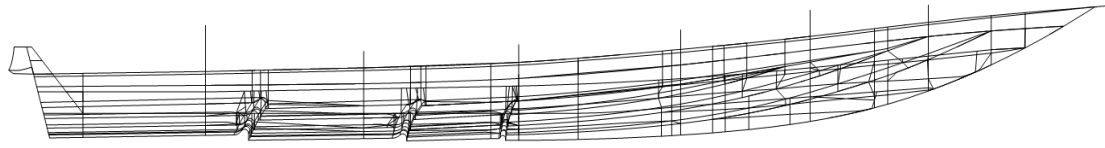
Σχήμα 3.2 : Τροποποιημένο σχέδιο, όπου οι φρακτές απεικονίζονται από τη μέση επιφάνειά τους.
