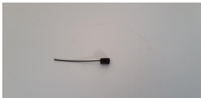
Σχήμα 5.7. Ανθρακούχο δοκίμιο μορφοποιημένο ως ηλεκτρόδιο
