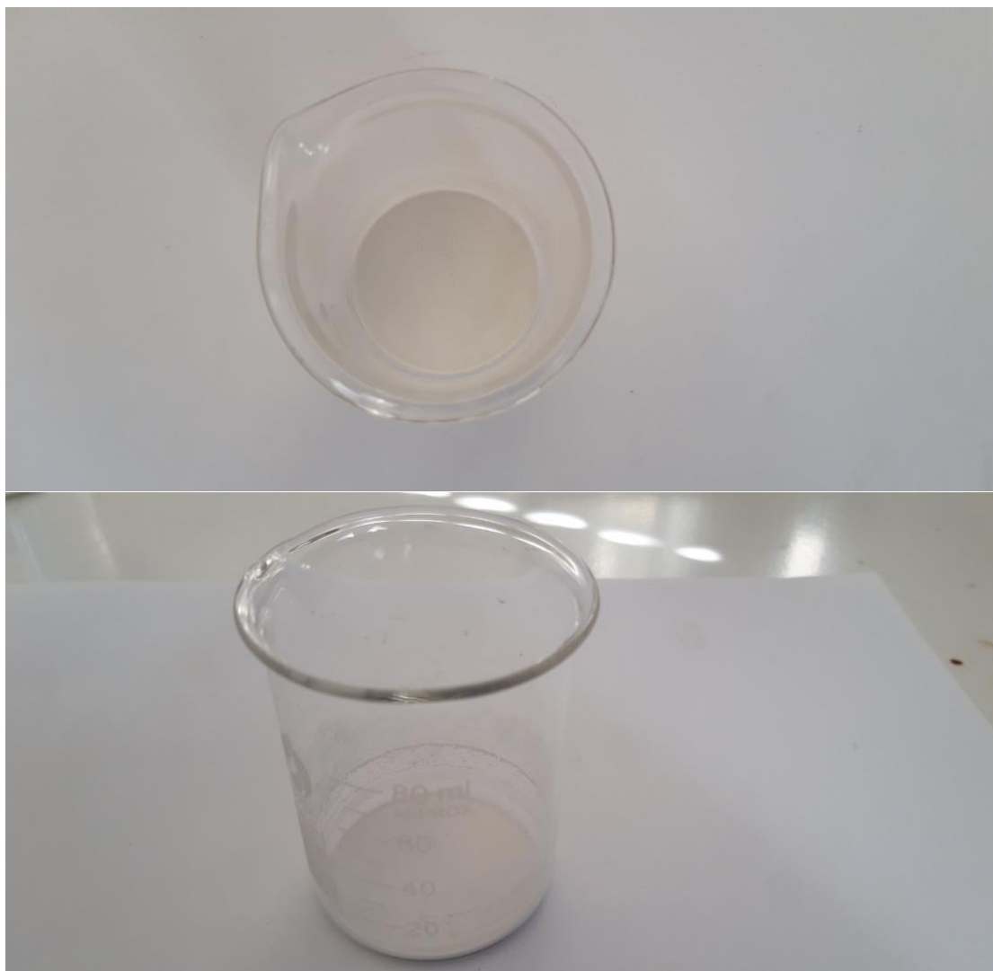
Σχήμα 6.5. Ίζημα ZnO σε ποτήρι ζέσεως μετά την ξήρανση
