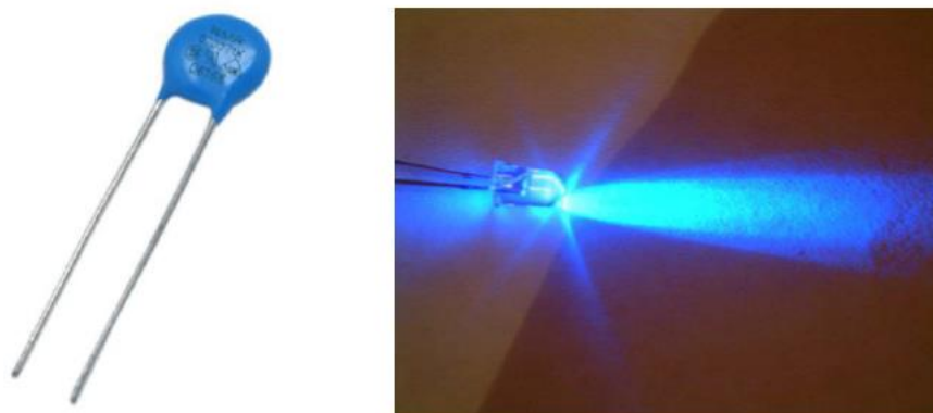
Σχήμα 3.8. Αριστερά απεικονίζεται ένας ZnO Varistor και δεξιά ένα LED
