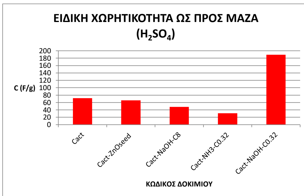
Σχήμα 9.16. Ραβδογράμματα ειδικής χωρητικότητας ως προς τη μάζα των ανθρακούχων δοκιμών που μετρήθηκαν μέσω κυκλικής βολταμετρίας σε διάλυμα H 2 SO 4 1 M (περιοχή δυναμικών -1 V έως + 1.5 V και πίσω, με ταχύτητα σάρωσης 5 mV/s)
