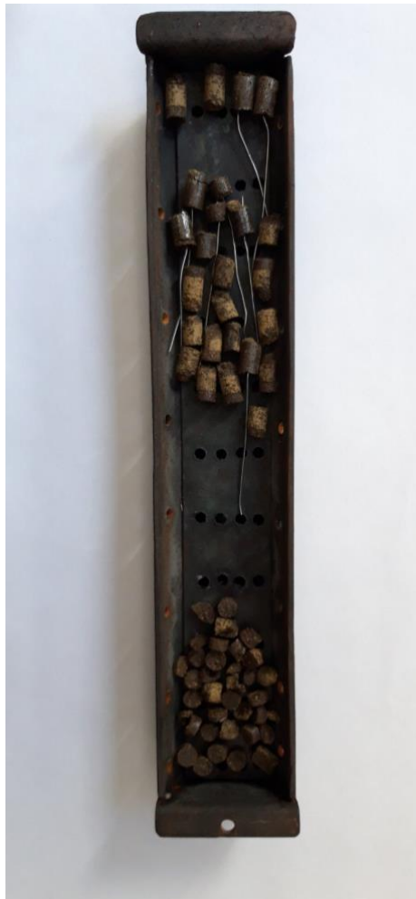
Σχήμα 5.4. Σκληρυμένα δοκίμια νεολάκης/βιόμαζας ελαιοπυρήνα
