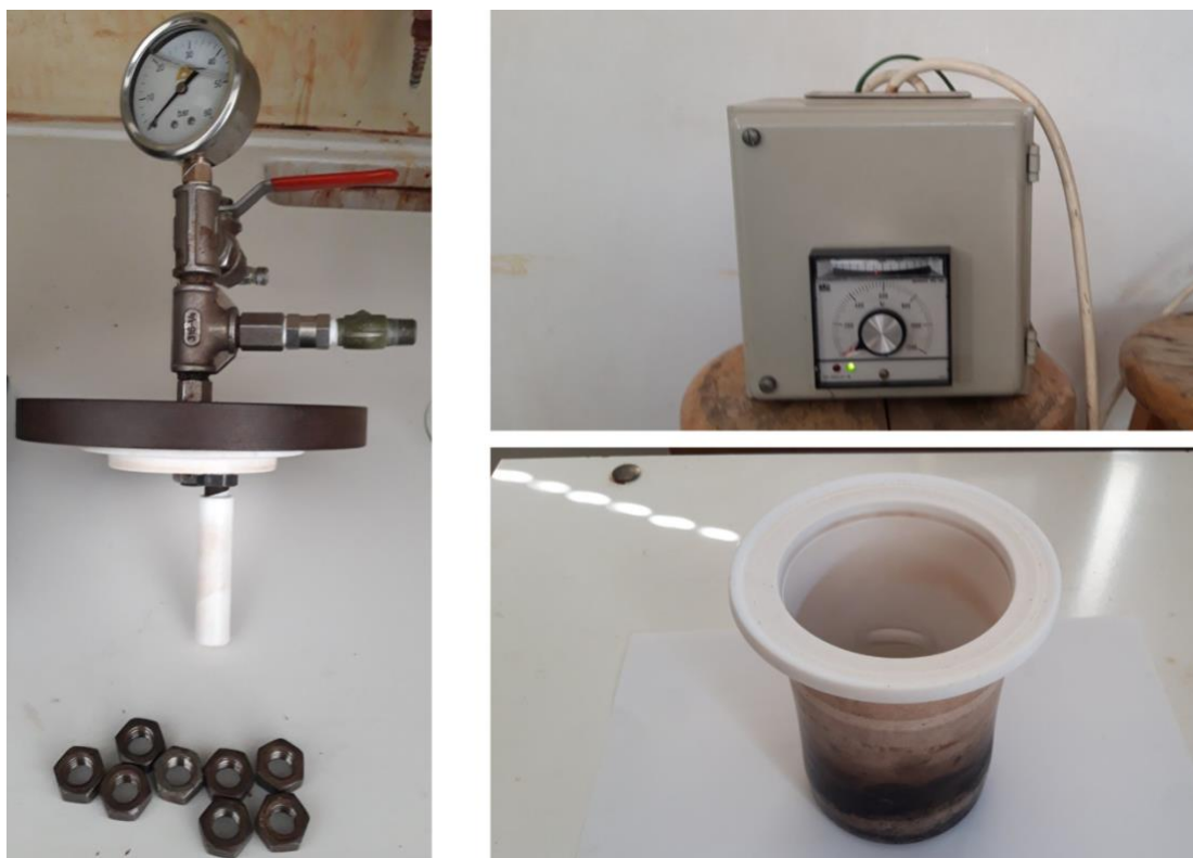
Σχήμα 6.2. Διάταξη αυτόκλειστου αντιδραστήρα (καπάκι με ενσωματωμένη βαλβίδα εκτόνωσης και μανόμετρο, ρυθμιστής θερμοκρασίας, στέλεχος από τεφλόν)
