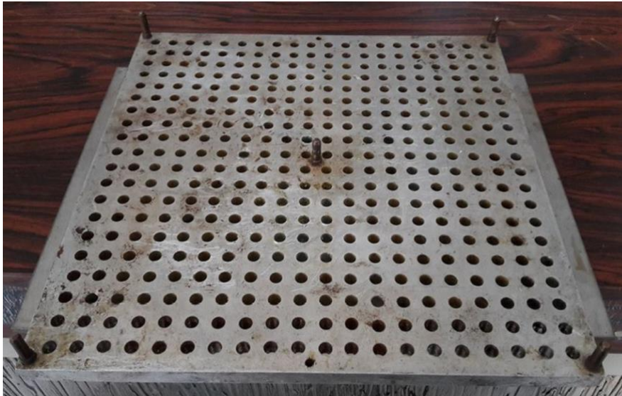
Σχήμα 5.3. Μήτρα μορφοποίησης (καλούπι) κυλινδρικών δοκιμίων
