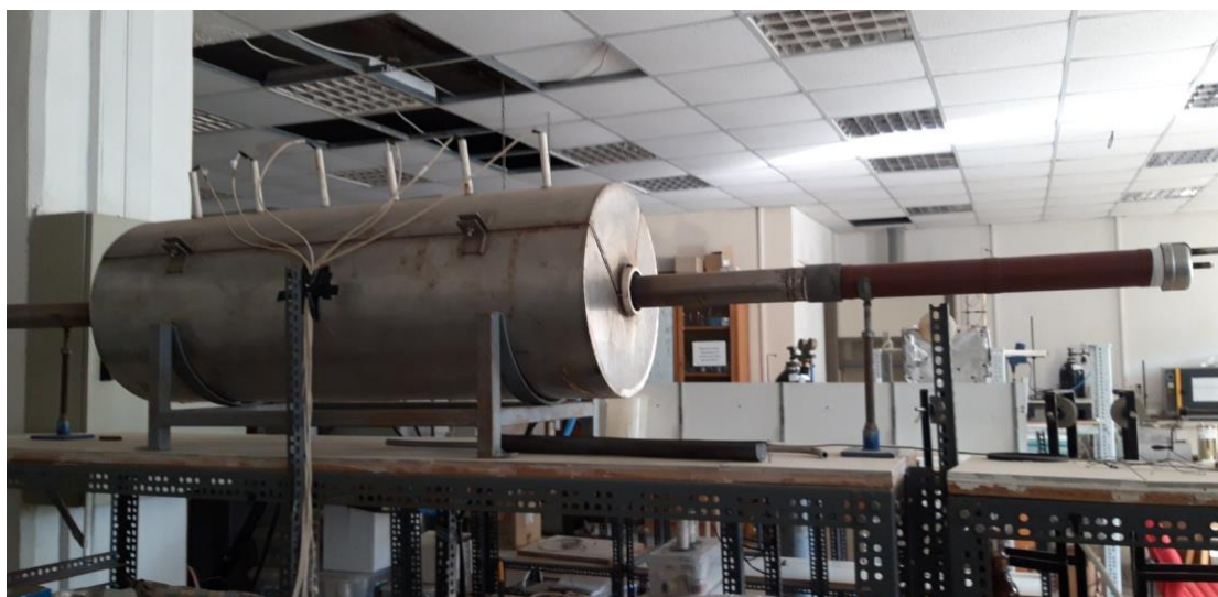
Σχήμα 5.5. Διάταξη φούρνου (σωληνωτός αντιδραστήρας)
