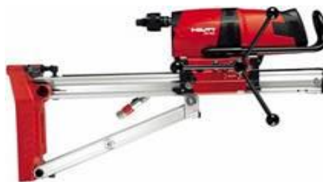
Σχήμα 1.6 – Περιστροφικός δειγματολήπτης. Η πυρηνοληψία πραγματοποιείται με αυτή τη συσκευή στην οποία αναρτάται διαμαντοκορώνα (συνήθως Φ100). Τα δοκίμια μορφώνονται, σπάνε στην ειδική πρέσα και η θλιπτική αντοχή που προκύπτει ανάγεται σε αντοχή κύβου 28 ημερών.
