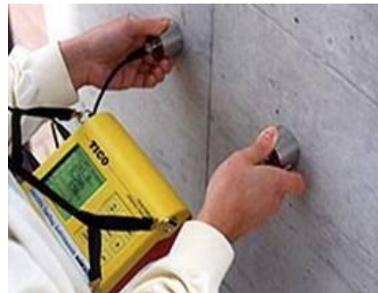
Σχήμα 1. 4 – Συσκευή υπερήχων. Βασίζεται στην ταχύτητα με την οποία διέρχονται οι υπέρηχοι από το σώμα του δομικού στοιχείου. Επιπλέον μπορεί να διαπιστώσει την ομοιομορφία του σκυροδέματος, την ύπαρξη και το βάθος των ρωγμών, το βάθος προσβολής από πυρκαγιά, τις αλλαγές που παρατηρούνται στο σκυροδέμα με το χρόνο, το μέτρο ελαστικότητας και τη σταθερά Poisson.
