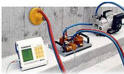
Σχήμα 1.5 – Σύστημα ελέγχου διαπερατότητας και απορροφητικότητας στοιχείων από σκυρόδεμα.
