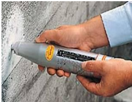
Σχήμα 1. 3 - Κρουσιμέτρο. Βασίζεται στην επιφανειακή σκληρότητα των δομικών στοιχείων. Ιδανικό για τη διαπίστωση της ομοιογένειας κυρίως πριν την εφαρμογή άλλων μεθόδων.
