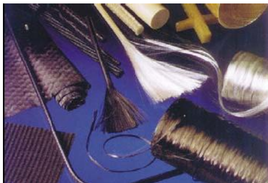
Σχήμα 2. 7 - Συνήθεις ίνες άνθρακα και γυαλιού και ινοπλισμένα πολυμερή (FRP)
