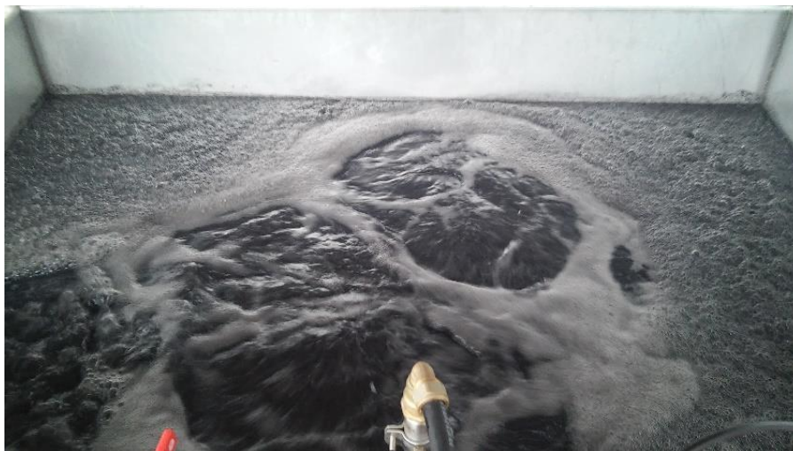
Εικόνα 44. Αερόβιο διαμέρισμα πιλοτικού συστήματος σε χαμηλό (άνω εικόνα) και έντονο (κάτω εικόνα) αερισμό
