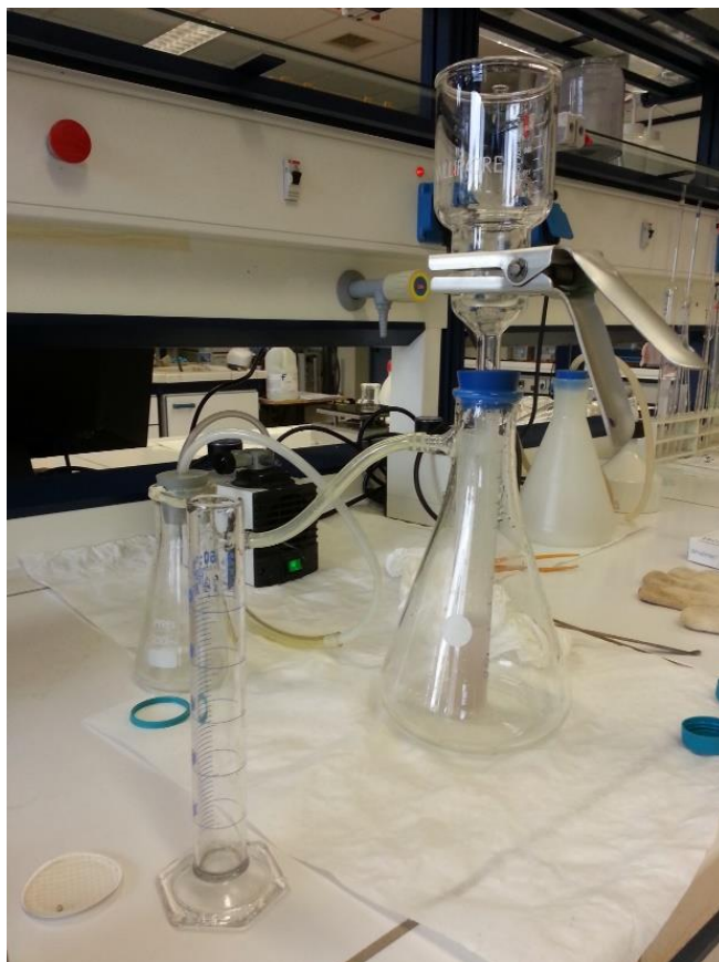
Εικόνα 22. Συσκευή διήθησης γυάλινη με αντλία κενού
