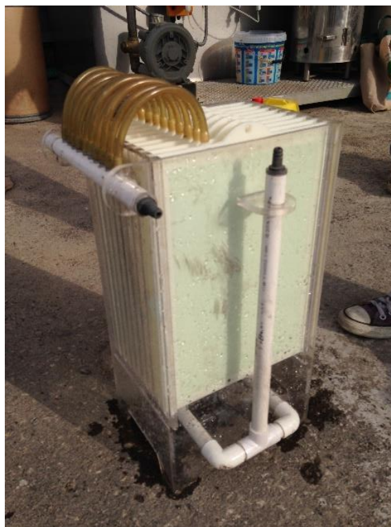
Εικόνα 14. Μονάδα μεμβρανών βιομηχανίας βαφής- φινιρίσματος κλωστοϋφαντουργίας
