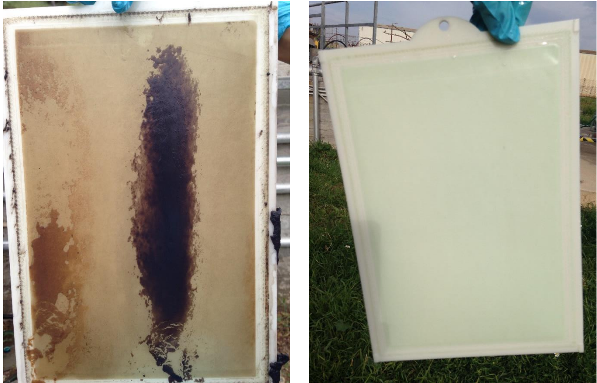
Εικόνα 17. Η μονάδα μεμβρανών πριν και μετά τον χημικό καθαρισμό
