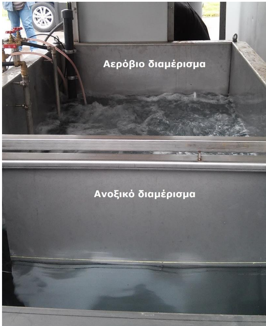
Εικόνα 40. Αερόβιο διαμέρισμα με αερισμό και ανοξικό διαμέρισμα χωρίς αερισμό
