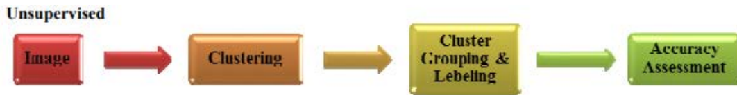
Εικόνα 2-3 Πορεία Μη Επιβλεπόμενης Ταξινόμησης (Πηγή: Al-doski, 2013, p.p. 143)[17]
