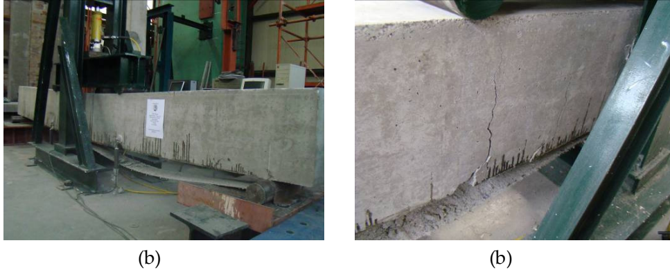
Εικόνα 4.7: Πείραμα 2 ο : (a): Αποκόλληση σε όλο το μήκος της δοκού στο τέλος της δοκιμής, (b): Καμπτική ρωγμή στο μέσο του ανοίγματος της δοκού στο τέλος της δοκιμής
