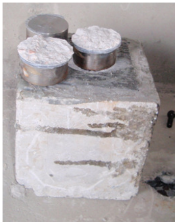
Εικόνα 7.9: Απεικόνιση του αποτελέσματος των δοκιμών από το τέταρτο κυβικό δοκίμιο
