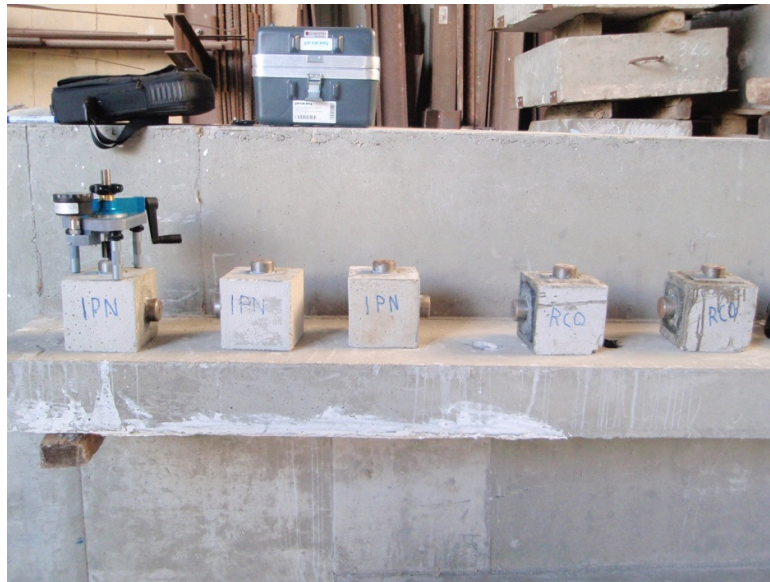
Εικόνα 7.5: Απεικόνιση των πέντε κυβικών δοκιμίων που χρησιμοποιήθηκαν για τα πειράματα της εξόλκευσης
