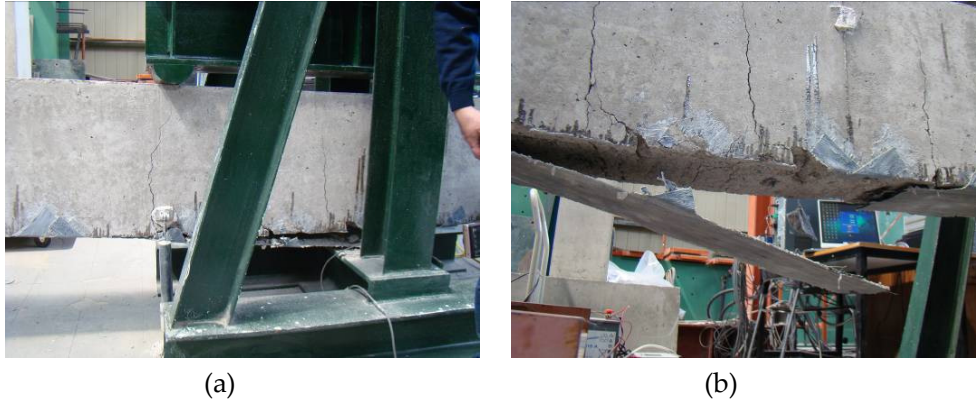
Εικόνα 4.8: Πείραμα 3 ο : (a), (b): Αποκόλληση σε όλο το μήκος της δοκού στο τέλος της δοκιμής, θραύση του ΙΟΠ
