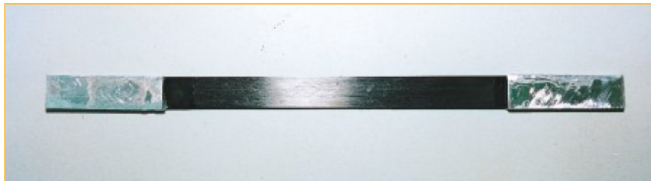
Εικόνα 1.4: Δείγμα ΙΟΠ για τον προσδιορισμό της εφελκυστικής αντοχής του
