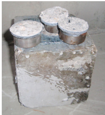
Εικόνα 7.10: Απεικόνιση του αποτελέσματος των δοκιμών από το πέμπτο κυβικό δοκίμιο
