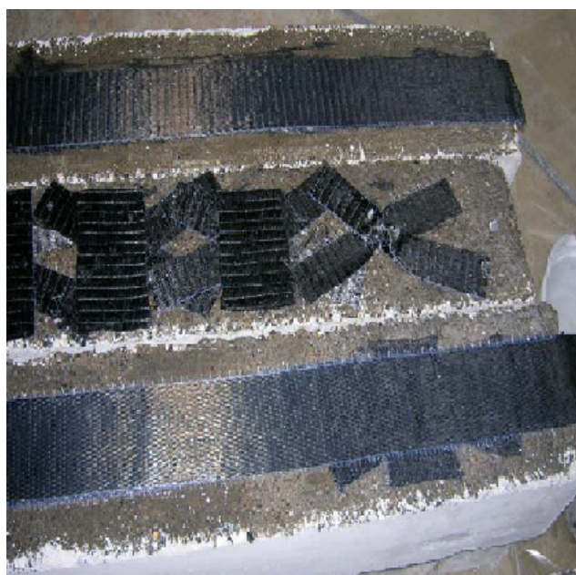
Εικόνα 4.2: Τρόπος τοποθέτησης αγκυριών και φύλλων ΙΟΠ
