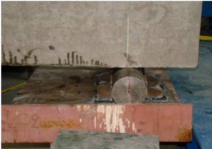
Εικόνα 4.5: Κυλιόμενες στηρίξεις δοκών
