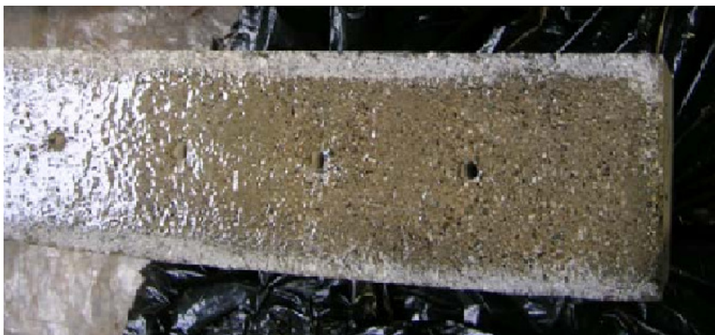
Εικόνα 4.1: Τρόπος διάνοιξης οπών για την τοποθέτηση αγκυριών
