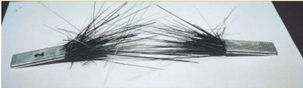
Εικόνα 1.6: Αστοχία δείγματος ΙΟΠ.
