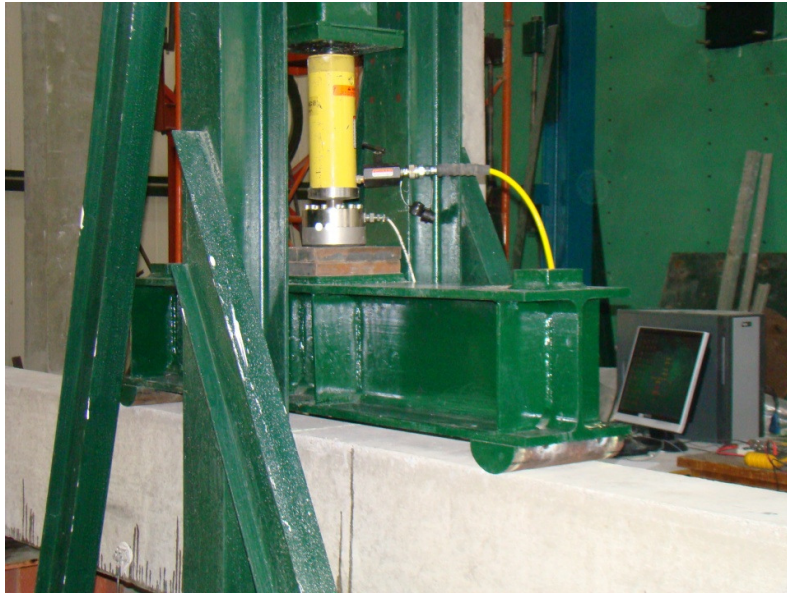
Εικόνα 4.3: Τρόπος επιβολής του φορτίου
