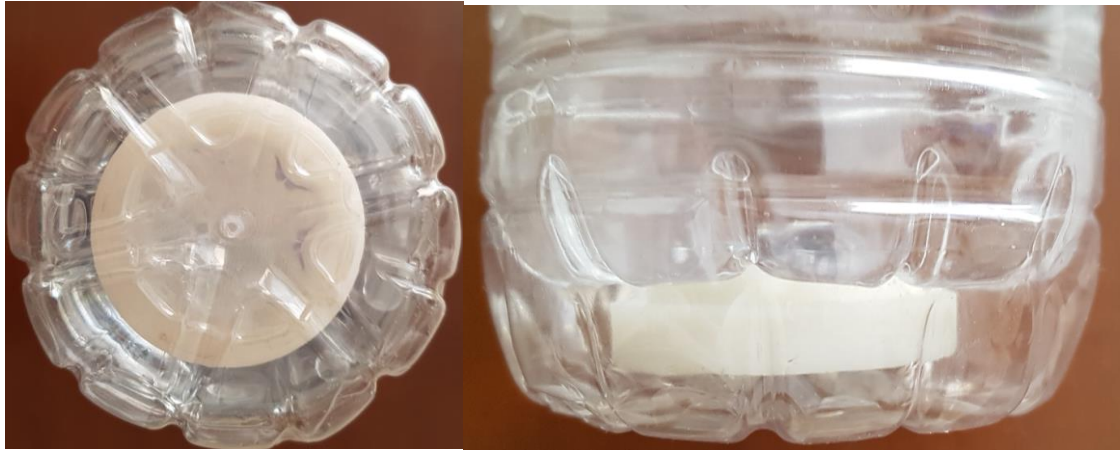
Σχήμα 6- 13: Ο ηλεκτρονικός πομπός στη θήκη του, τοποθετημένος ανάμεσα σε δύο πάτους μπουκαλιού 1,5 λίτρου
