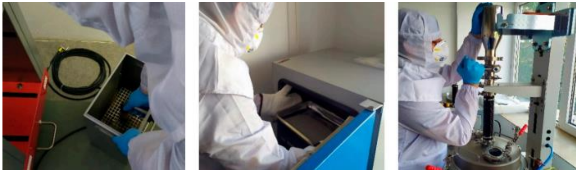
Σχήμα 5-3-4: Η διαδικασία ανάκτησης πούδρας, φάση 1 η , 2 η , και 3 η αντίστοιχα, υιοθετημένο από τους Daraban et al. (2019)
