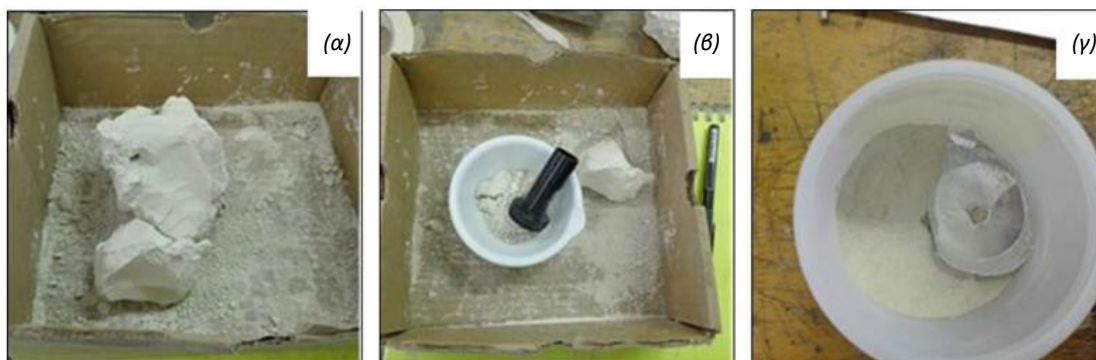
Σχήμα 5-3- 32: Προετοιμασία του πετρώματος “Lecce” στην αρχιτεκτονική, (α) Φύρα πετρώματος (β) Σύνθλιψη του (γ) Κοσκίνισμα της πούδρας, υιοθετημένο από τους Esposito Corcione et al. (2018)
