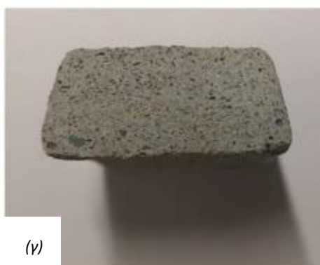
Σχήμα 5-3- 21: (α) Εκτυπωμένο αντικείμενο από σκυρόδεμα με ανακυκλωμένο γυαλί (β) Διατομή αντικειμένου από καθαρή άμμο (γ) Διατομή αντικειμένου από ανακυκλωμένο γυαλί, υιοθετημένο από τους Ting et al. (2019)
