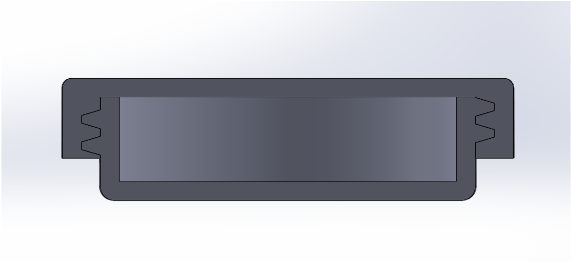
Σχήμα 6- 9: Η συναρμογή των δύο επιμέρους τεμαχίων, σε τομή κατά τον κατακόρυφο άξονα, σε πρόσοψη
