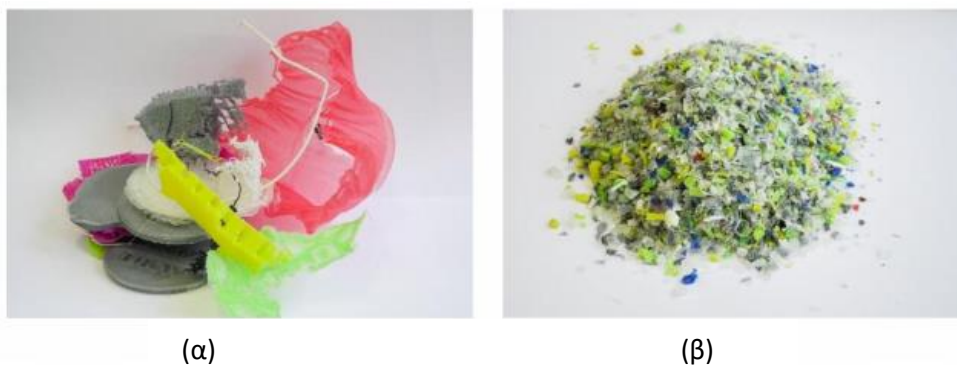
Σχήμα 5-2- 68: Απόβλητο PLA κατά τους Paciorek-Sadowska et al. (2019) (α) μετά την τρισδιάστατη εκτύπωση (β) αφότου περάσει από την μηχανή σύνθλιψης
