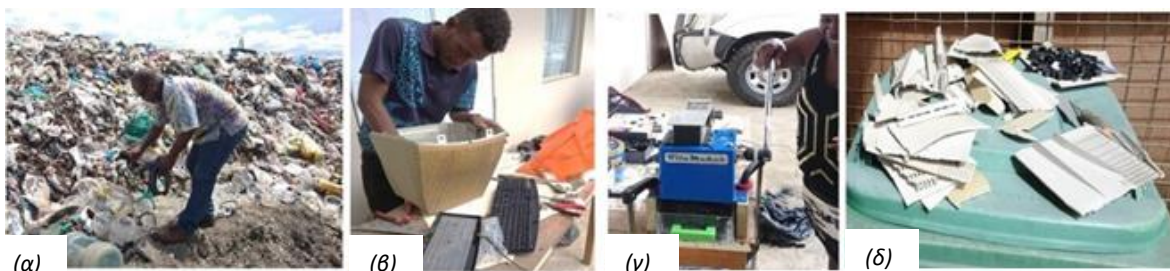
Σχήμα 5-2-13: Η διαδικασία ανάκτησης πλαστικού και προετοιμασίας του για κοκκοποίηση, από το πείραμα των Mohammed et al. (2019), (α) Συλλογή πλαστικών (β) αποσυναρμολόγηση τους στα επιμέρους κομμάτια (γ) σύνθλιψη (δ) αφυδάτωση και ξήρανση τους
