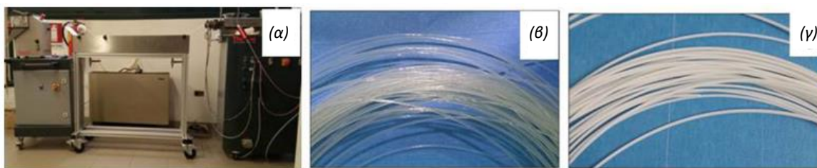
Σχήμα 5-3- 43: (α) Εξώθηση νήματος (β) Καθαρό νήμα PLA (γ) Ενισχυμένο νήμα PLA με φύρα πετρώματος Leece, υιοθετημένο από τους Esposito Corcione et al. (2018)
