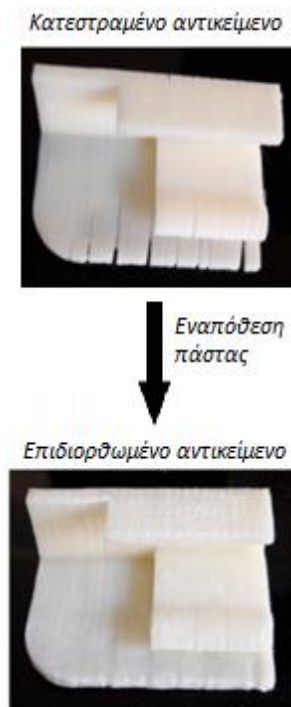
Σχήμα 5-4- 14: Σχηματική αναπαράσταση της διαδικασίας επιδιόρθωσης με την βοήθεια πάστας ανακυκλωμένου υλικού, υιοθετημένο από τους Cunico et al. (2019)
