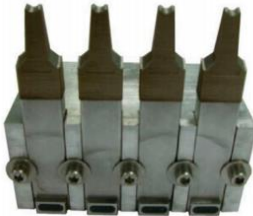
Σχήμα 5-4-3: Επιδιορθωμένα καλούπια με κορυφές, με ειδικούς αγωγούς ψύξης, κατασκευασμένα μέσω ΠΚ, υιοθετημένο από τους Daraban et al. (2019)
