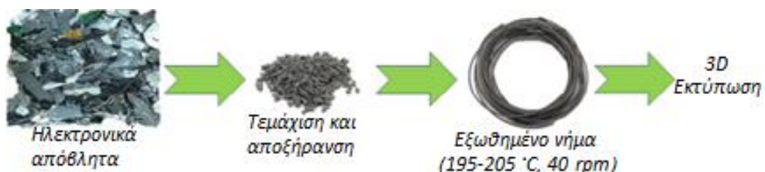
Σχήμα 5-2- 8: Σχηματική αναπαράσταση μετατροπής ηλεκτρονικών αποβλήτων σε πλαστικό νήμα για ΠΚ, από τους Gaikwad et al. (2018)
