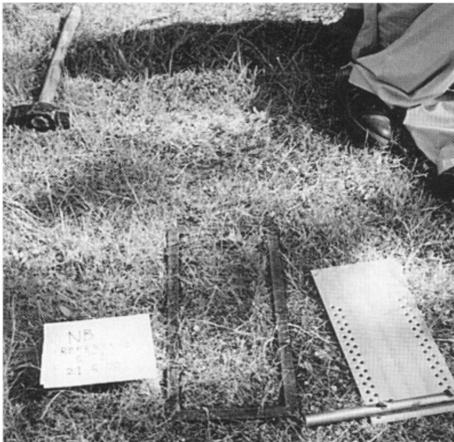
Σχήμα 3.1 Συνιστώσες του scraper plate
