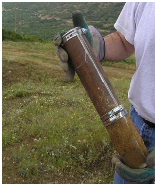
Σχήμα 3.5 Ο δειγματολήπτης που αναπτύχθηκε στα πλαίσια της ΔΕ
