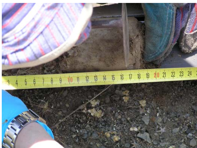
Σχήμα 3.10 Διάρθρωση του προφίλ του χώματος σε τμήματα, προκειμένου να προσδιορισθεί η κατά βάθος κατανομή του Cs-137
