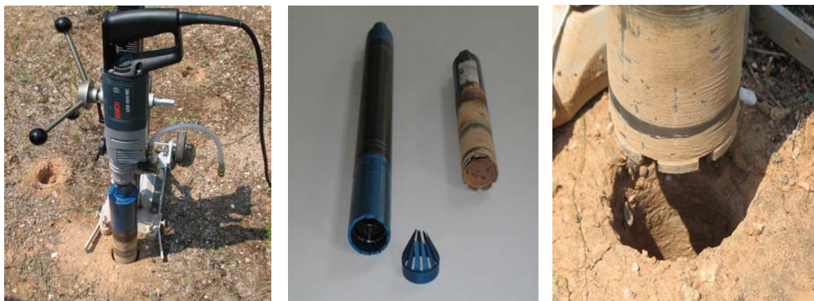
Σχήμα 3.4 Ηλεκτρικό δράπανο και λοιπός εξοπλισμός δειγματοληψίας που χρησιμοποιείται στο ΕΠΤ-ΕΜΠ για δειγματοληψία χώματος από βάθος.
