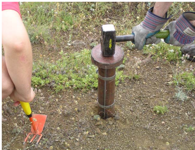
Σχήμα 3.6 Διαδικασία εισόδου του δειγματολήπτη στο έδαφος
