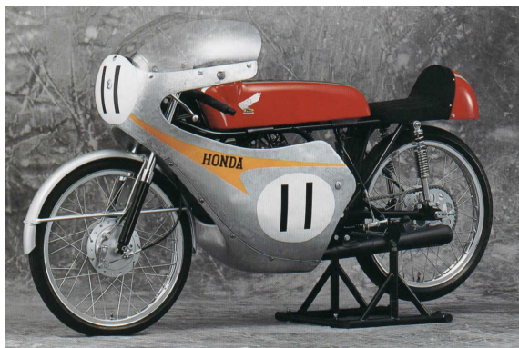
(α') Honda RC110, Τετράχρονος μονοκύλινδρος κινητήρας 50 cm 3 , 1961-1962.
