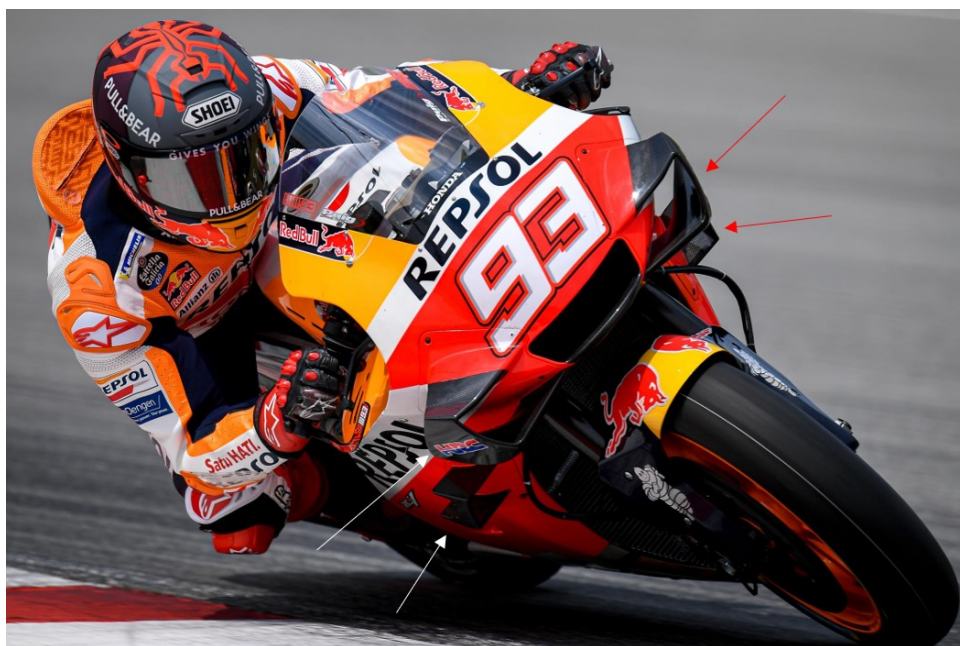
(γ') Honda RC213V, Τετράχρονος τετρακύλινδρος κινητήρας 1000 cm 3 , 2012-Σήμερα. Τα αεροδυναμικά βοηθήματα διευκρινίζονται με τα βέλη.
