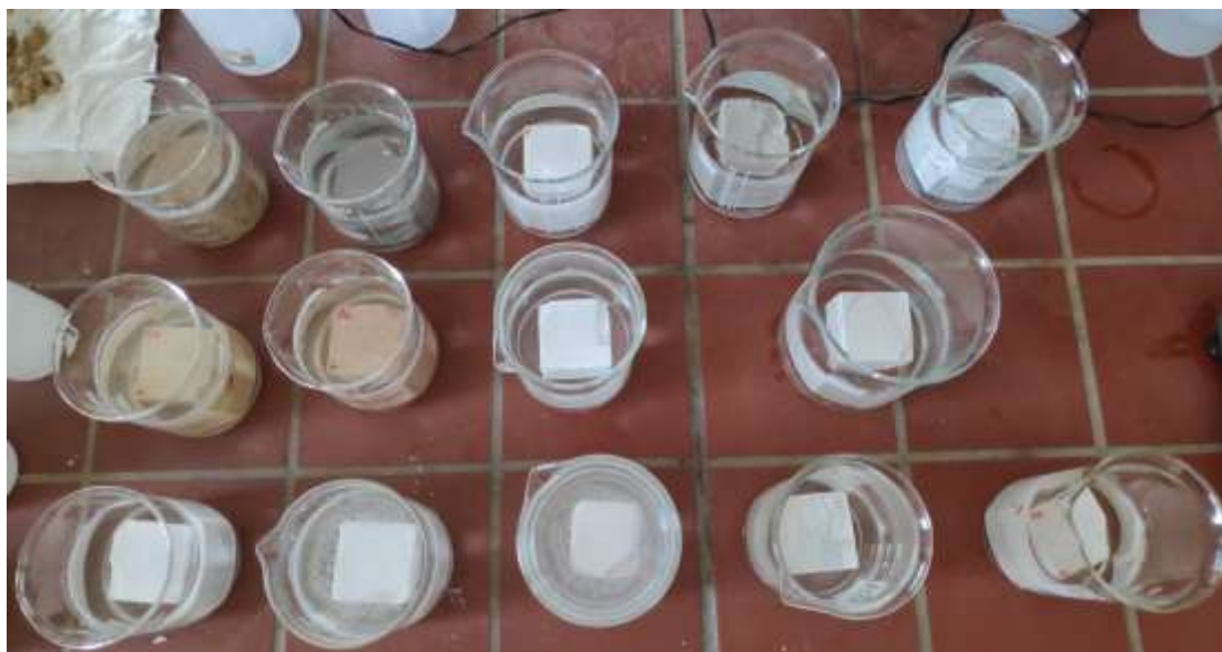
Εικόνα 30. Δοκιμές εμβάπτισης για όλα τα εξεταζόμενα δοκίμια
