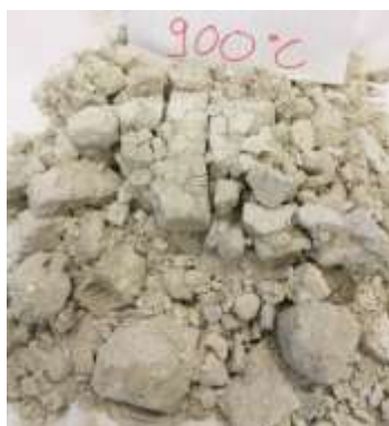
Εικόνα 31. Λιθότυπος Lecce ύστερα από θέρμανση στους 900°C
