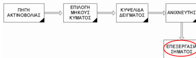
Σχήμα 32. Διάγραμμα ροής λειτουργίας φασματοφωτόμετρου υπεριώδους-ορατού [51]
