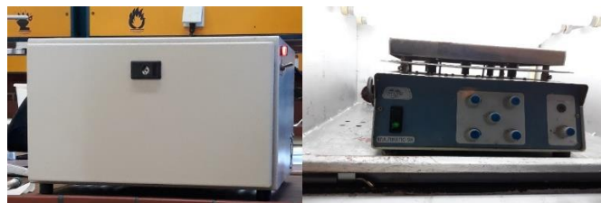
Εικόνα 20. Όργανο φωτοαντίδρασης (αριστερά). Μαγνητικός αναδευτήρας 5 θέσεων στο εσωτερικό του οργάνου και λαμπτήρες ορατού φωτός (δεξιά).
