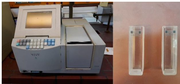
Εικόνα 18. Όργανο μέτρησης απορρόφησης στο υπεριώδες-ορατό (αριστερά). Κυψελίδες τοποθέτησης δειγμάτων στο όργανο (δεξιά).
