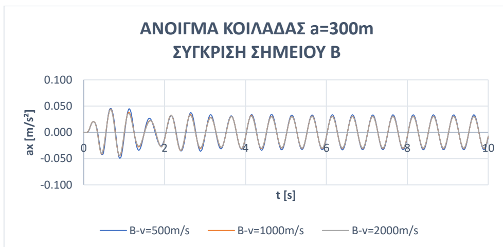
Διάγραμμα 4.1.187: Διάγραμμα επιτάχυνσης a_x [ m/s^2 ] συναρτήσει του χρόνου t(s) σύγκριση σημείου B, για ταχύτητα διάδοσης κύματος V_s=500m/s , V_s=1000m/s & V_s=2000m/s , άνοιγμα κοιλάδας a=300m και διέγερση f=2Hz (SIN-2hz)
