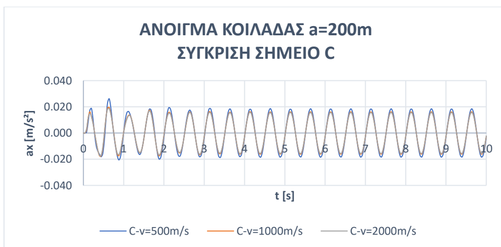
Διάγραμμα 4.1.182: Διάγραμμα επιτάχυνσης a_x [ m/s^2 ] συναρτήσει του χρόνου t(s) σύγκριση σημείου C, για ταχύτητα διάδοσης κύματος V_s=500m/s , V_s=1000m/s & V_s=2000m/s , άνοιγμα κοιλάδας a=200m και διέγερση f=2Hz (SIN-2hz)
