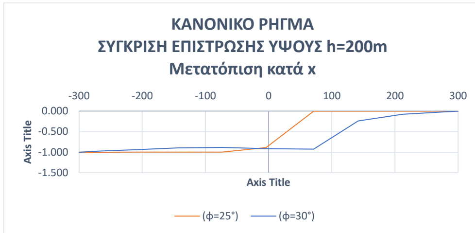
Διάγραμμα 4.2.7: Διάγραμμα κανονικού ρήγματος, καθίζησης \delta v(m) συναρτήσει της μετατόπισης x(m) κατά τον άξονα x , για σύγκριση επίστρωσης ύψους h=200m και για γωνίες τριβής \varphi=25^\circ & \varphi=30^\circ
