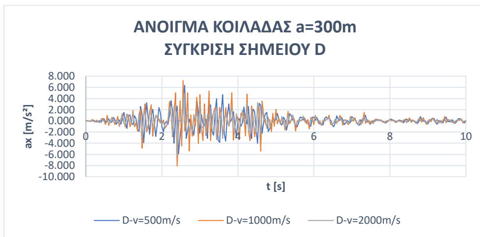
Διάγραμμα 4.1.165: Διάγραμμα επιτάχυνσης a_x [ m/s^2 ] συναρτήσει του χρόνου t(s) σύγκριση σημείου D, για ταχύτητα διάδοσης κύματος V_s=500m/s , V_s=1000m/s & V_s=2000m/s , άνοιγμα κοιλάδας a=300m και διέγερση 225^\alpha
