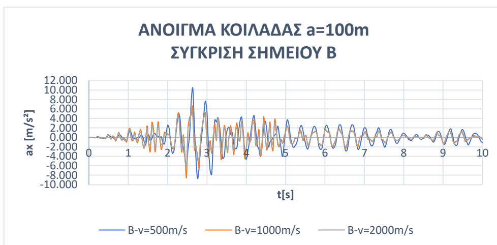
Διάγραμμα 4.1.151: Διάγραμμα επιτάχυνσης a_x [ m/s^2 ] συναρτήσει του χρόνου t(s) σύγκριση σημείου B, για ταχύτητα διάδοσης κύματος V_s=500m/s , V_s=1000m/s & V_s=2000m/s , άνοιγμα κοιλάδας a=100m και διέγερση 225^\alpha
