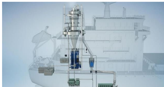
Σχήμα 1.6: Συσκευή επεξεργασίας καυσαερίων (scrubber) εγκατεστημένη σε μηχανοστάσιο πλοίου [69].
