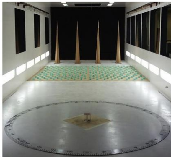
Σχήμα 7.2. Διάταξη για την προσομοίωση της ροής γύρω από πρότυπο κύβο μέσα στην αεροσήραγγα. [69]
