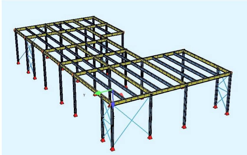
Σχήμα 4.2: Τρισδιάστατη απεικόνιση μεταλλικού φορέα (Sofistik)
