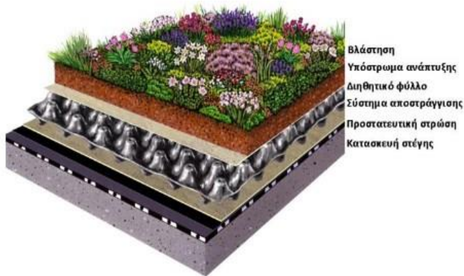
Σχήμα 2.7: Τυπικά στρώματα φυτεμένου δώματος (Πηγή : https://www.egreen.gr )
