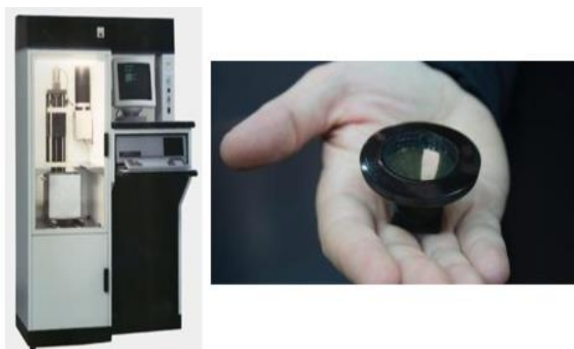
Σχήμα 1.28. Απόκομα εικόνων του μοντέλου SLA-1 (αριστερά) και του πρώτου αντικειμένου που εκτυπώθηκε (δεξιά) («Training in 3D Printing to Foster Eu Innovation & Creativity», 2016).
