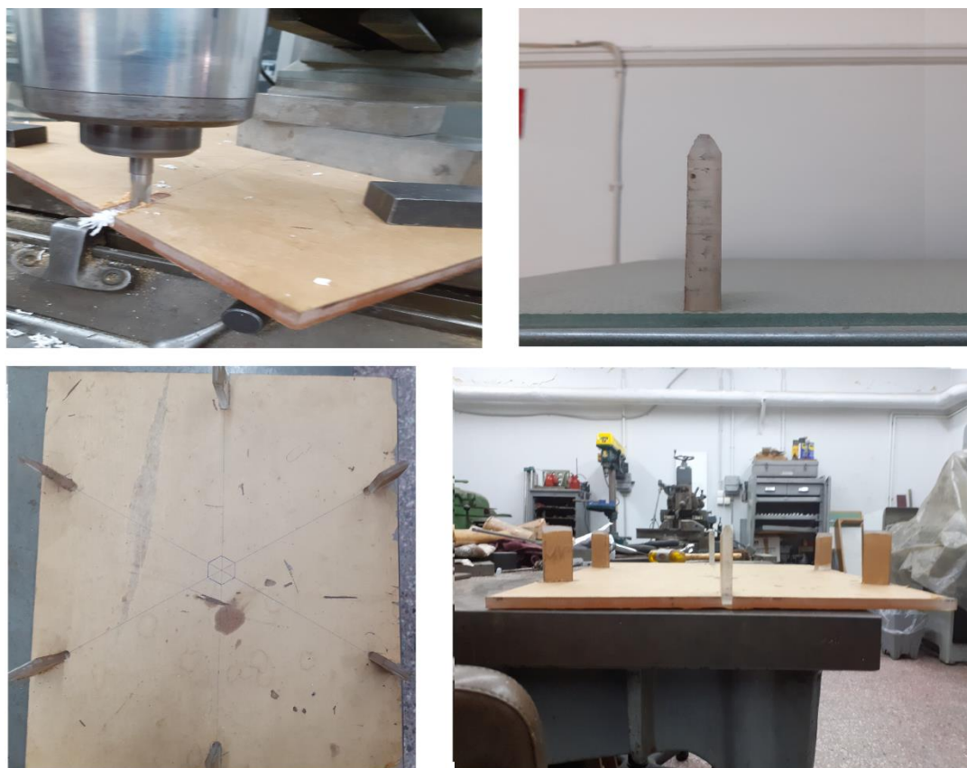
Σχήμα 5.21. Δημιουργία θέσης στήριξης (πάνω αριστερά), στήριξη (πάνω δεξιά), η βάση με τις τοποθετημένες στηρίξεις σε κάτωψη και πρόσοψη (κάτω αριστερά και δεξιά).
