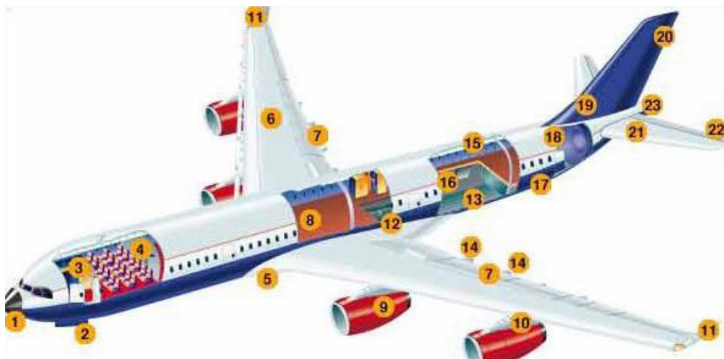
Σχήμα 1.8. Τμήματα αεροσκάφους τα οποία εμπεριέχουν honeycomb sandwich (Petrović et al., 2015).
