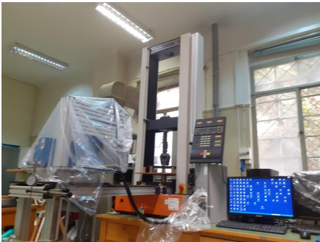
Σχήμα 5.20. Μηχανή Instron 1121 (προσφορά του Εργαστηρίου της κ.Ευαγγελίας Κοντού Καθηγήτριας ΕΜΠ, τομέας Μηχανικής, Σχολή Εφαρμοσμένων Μαθηματικών & Φυσικών Επιστημών ΕΜΠ).
