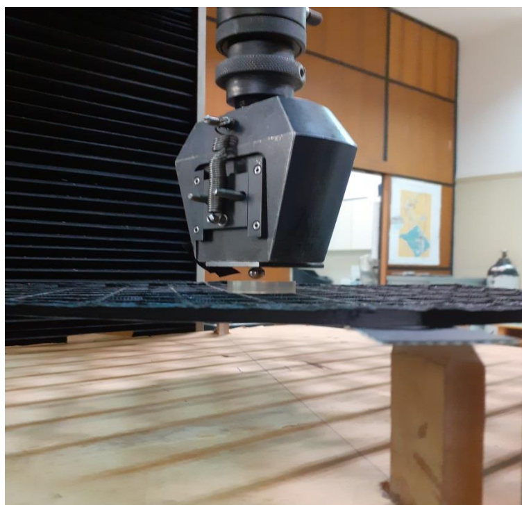
Σχήμα 5.24. Η αρπάγη, το σφαιρίδιο, το κυκλικό πλακίδιο, η εσχάρα, η λωρίδα, η στήριξη και η βάση.
