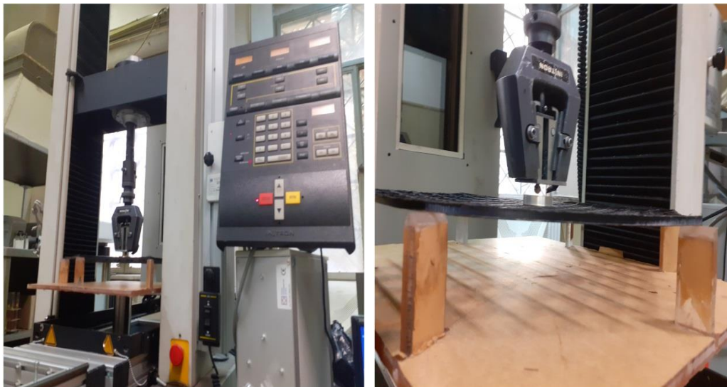
Σχήμα 5.23. Τοποθέτηση εσχάρας εντός πειραματικής διατάξεως.
