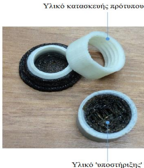
Σχήμα 1.30. Τα υλικά κατασκευής και υποστήριξης της μεθόδου FFF («Training in 3D Printing to Foster Eu Innovation & Creativity», 2016).
