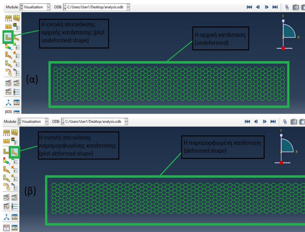
Σχήμα Β.2.5. Η αρχική (α) και η παραμορφωμένη (β) κατάσταση.
