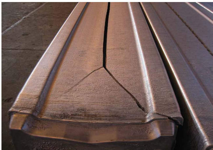
Εικόνα 9: Τυπική μορφολογία ψυχρής ρηγμάτωσης σε πλινθώμα. Πηγή: [10]
