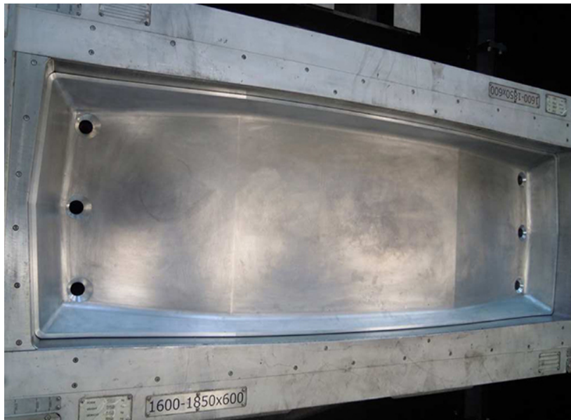
Εικόνα 14: Διάταξη πυθμένα εξοπλισμού DC χύτευσης στην οποία παρατηρείται η διαμόρφωση των πλάγιων πλευρών σε 2 ευθύγραμμα τμήματα με σκοπό την εξάλειψη του inward pull-in. Πηγή: [24]
