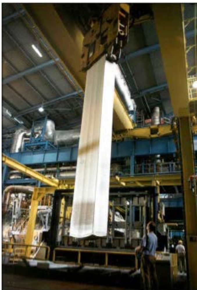
Εικόνα 6: Πλίνθωμα προερχόμενο από την DC χύτευση τη χρονική στιγμή που αποσύρεται από τη διάταξη της DC χύτευσης. Πηγή: [11]
