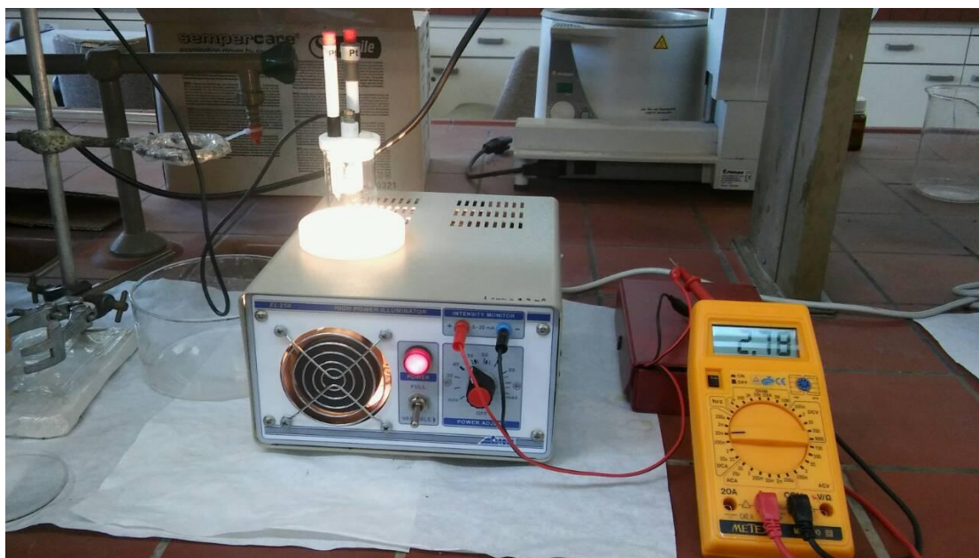
Εικόνα 32: Εργαστηριακή Διάταξη φωτοηλεκτροχημικού κελιού (PEC).
