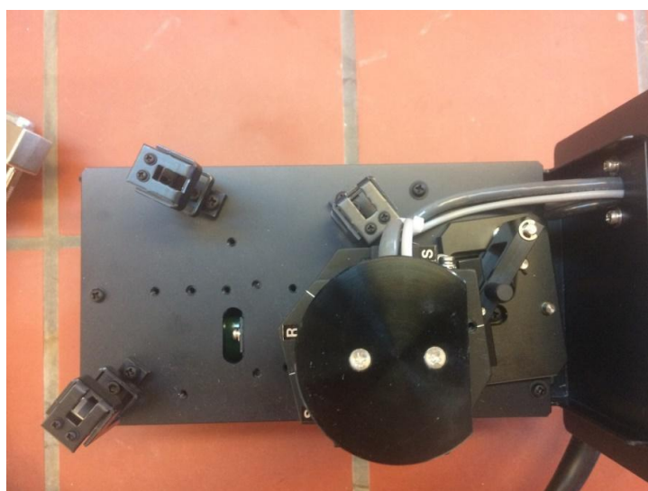
Εικόνα 28: Σφαίρα ολοκλήρωσης στην εργαστηριακή διάταξη UV-Vis (Λυρός, 2017).
