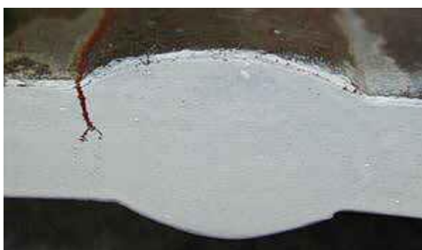
Εικόνα 4.1 Διάβρωση με μηχανική καταπόνηση
