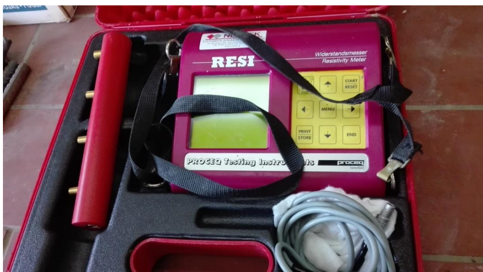
Εικόνα 10.8 Συσκευή μέτρησης της ειδικής αντίστασης σκυροδέματος
