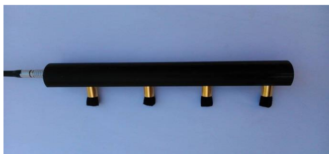
Εικόνα 8.1 Μετρητής αντίστασης τεσσάρων ηλεκτροδίων
