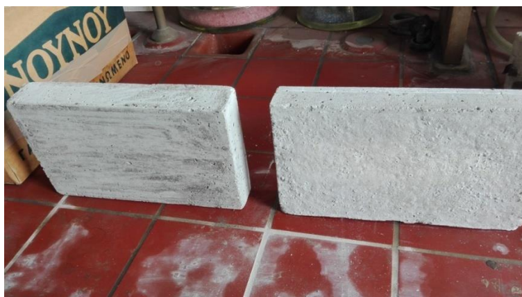
Εικόνα 9.8 Δοκίμια άοπλα τσιμεντοκονιάματος διαστάσεων 28 x 20 x 5 εκ
