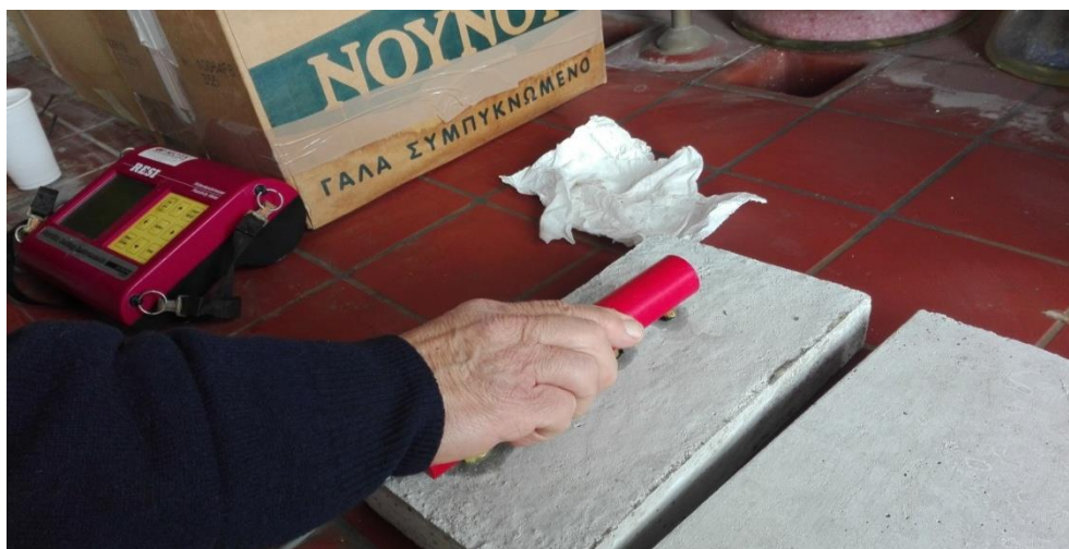
Εικόνα 10.9 Μέτρηση ειδικής αντίστασης σκυροδέματος
