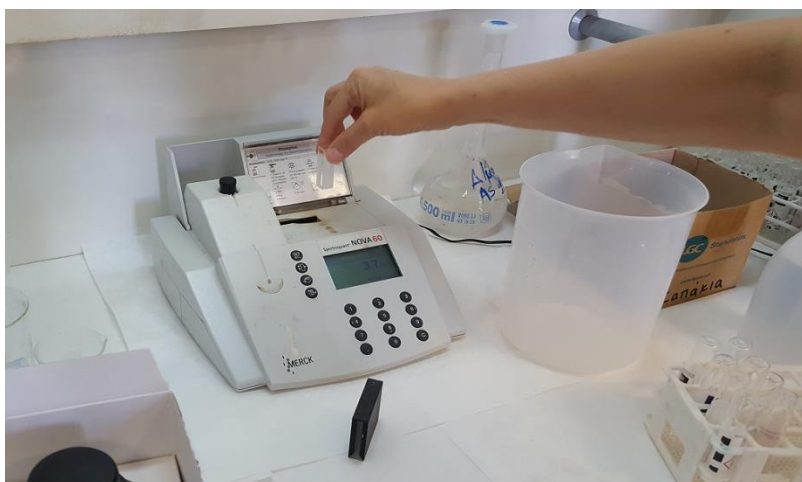
Εικόνα 10.12 Μέτρηση ανίχνευσης νιτρικών σε δείγματα σκυροδέματος.
