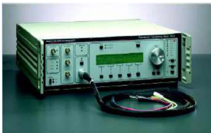
Εικόνα 9.7 Ποτενσιοστάτης γραμμικής πόλωσης E.G & Model 263
