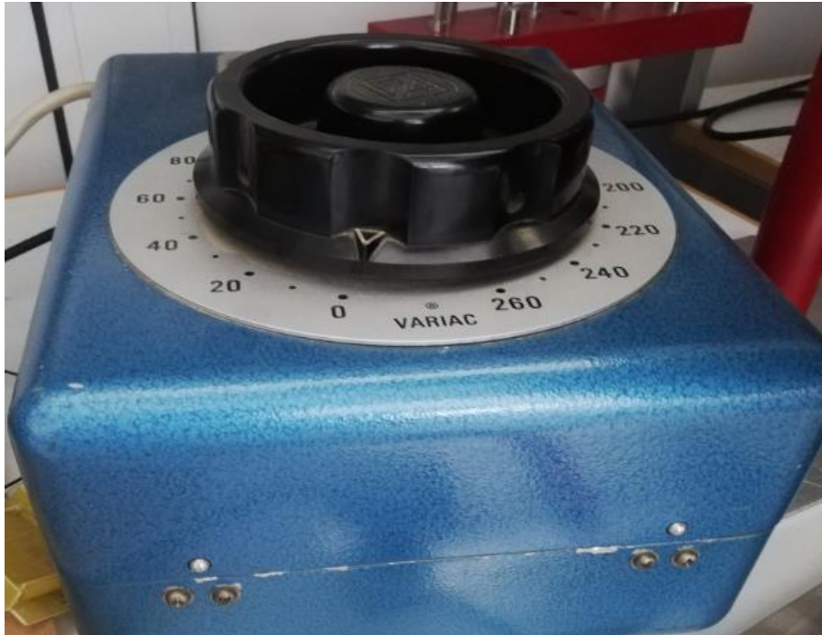
Σχήμα 3.28: Μεταβλητός Μετασχηματιστής Τάσης 260 V
