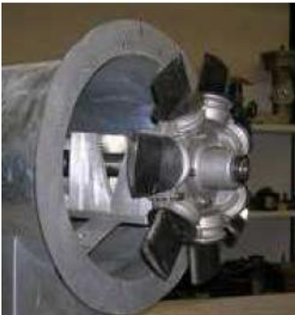
Εικόνα 74: Ένα πρωτότυπο μοντέλο αεροστρόβιλου Wells [95] (αριστερά). Το σκιαγράφημα του αεροστρόβιλου Wells [72] (δεξιά)
