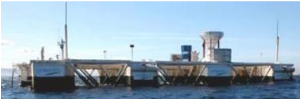
Εικόνα 61 : Το πιλοτικό μοντέλο Mk3, κλίμακας 1:3, τύπου blueWave της Oceanlinx [73]
