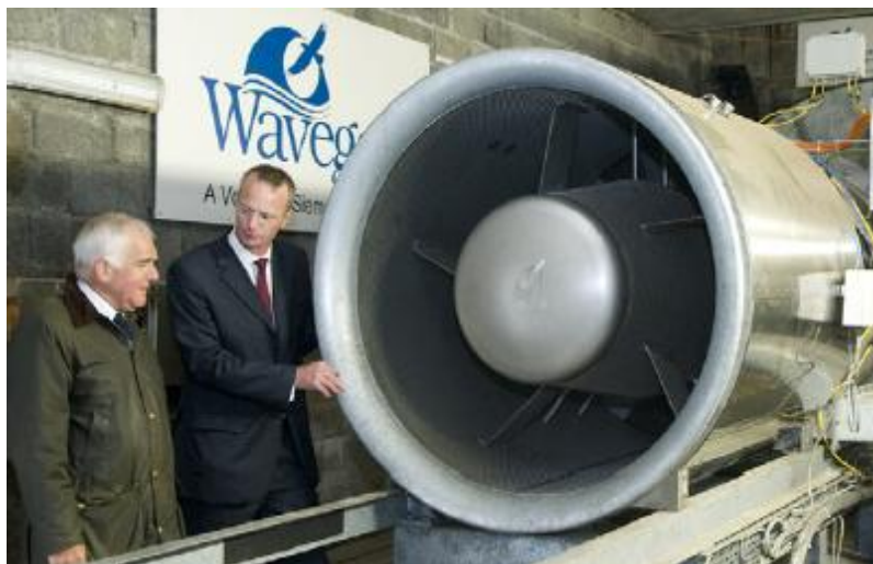
Εικόνα 49: Ο αεροστρόβιλος Voith Hydro Wavegen RT2 LIMPET (110 kW) [73]
