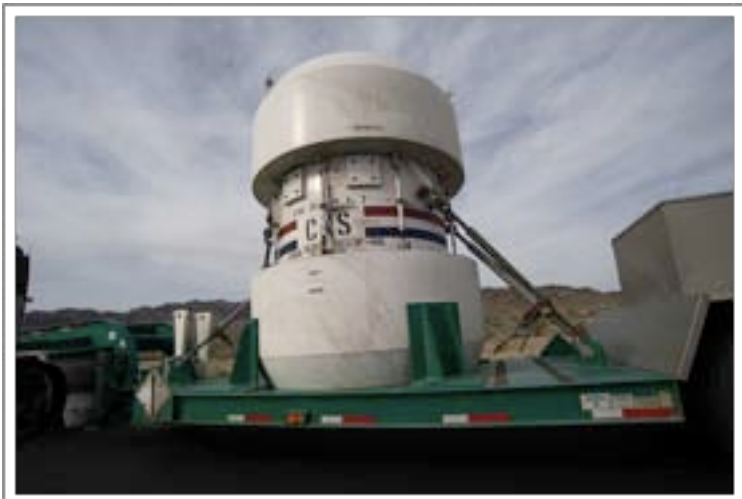
Εικόνα 4: Σύγχρονα κιβώτια μεταφοράς πυρηνικών αποβλήτων
