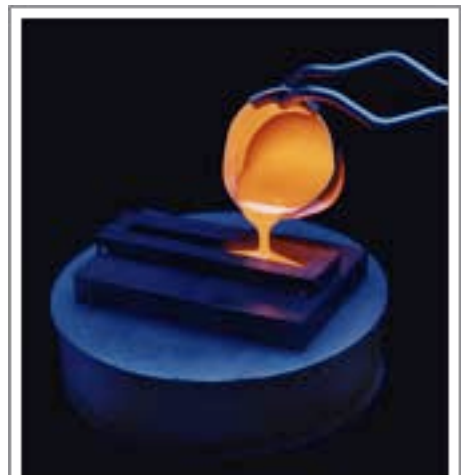
Εικόνα 5: Πείραμα υαλοποίησης για μελέτη της αποθήκευσης πυρηνικών αποβλήτων
