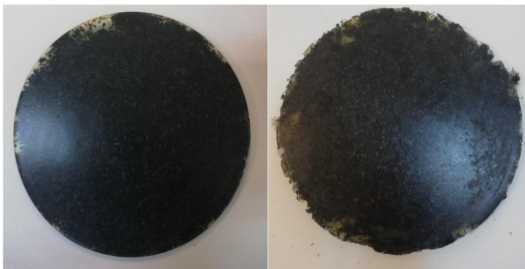
Εικόνα 9.15: Δοκίμιο Epoxy-CF (αριστερά) και Δοκίμιο Epoxy-CF-Kat2.5 (δεξιά) για την μέτρηση των θερμικών ιδιοτήτων.
