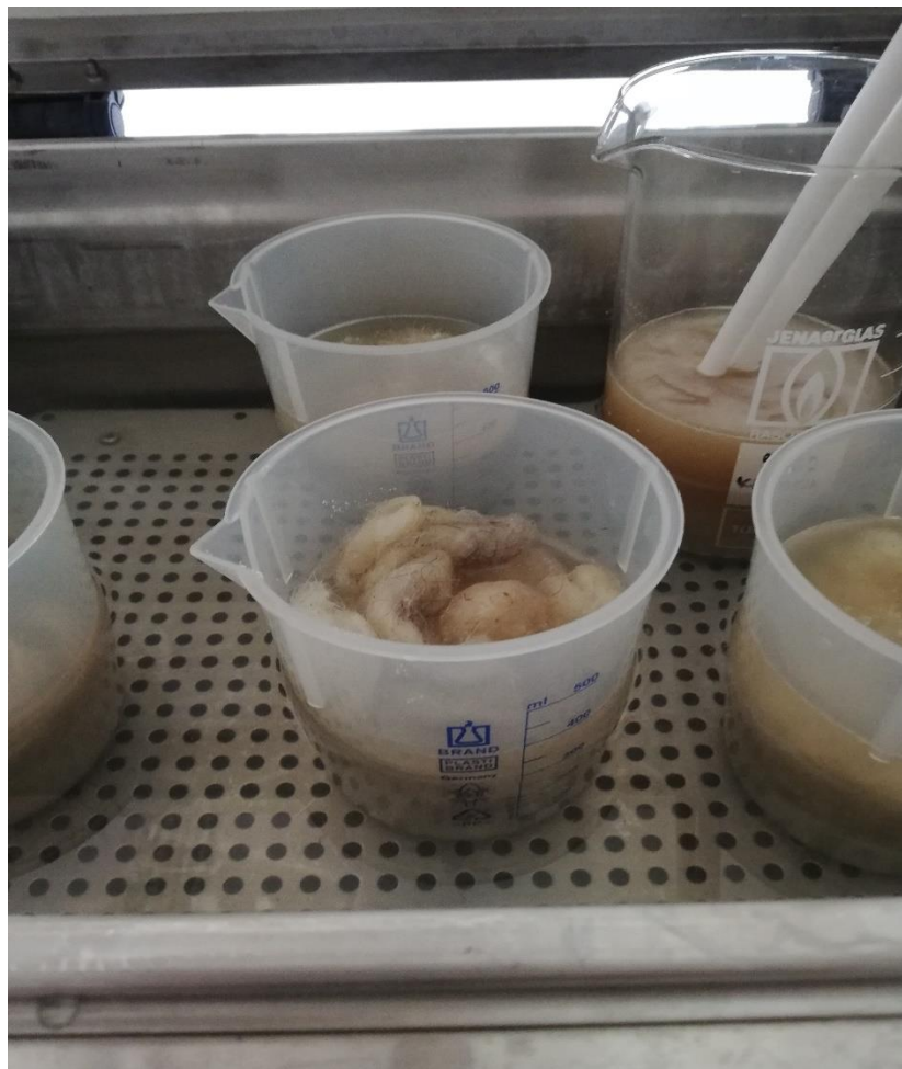
Εικόνα 6.11: Διαδικασία πλυσίματος του ερίου.
