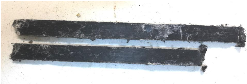
Εικόνα 7.3: Σύνθετα εποξειδικής μήτρας με προσθήκη μαλλιού (2,5%) και ίνες άνθρακα 5%.
