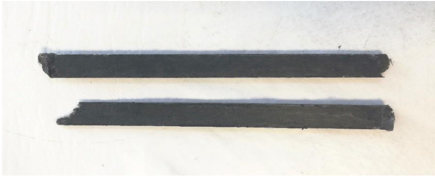
Εικόνα 7.2: Σύνθετα εποξειδικής μήτρας και ινών άνθρακα 5%.
