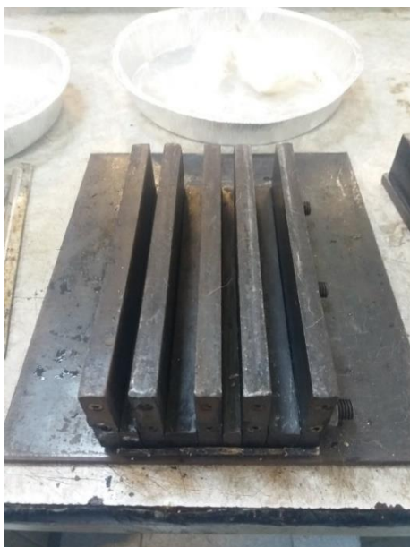
Εικόνα 7.13: Το μεταλλικό καλούπι που χρησιμοποιήθηκε κατά τη διαδικασία.
