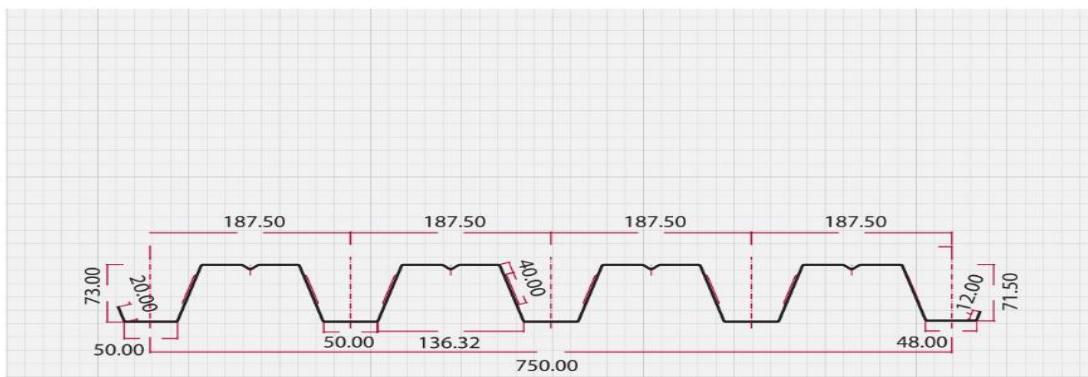
Σχήμα 3.25 Γεωμετρία χαλυβδόφυλλου
