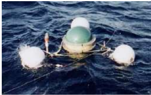
Εικόνα 3.4 Πλωτός Σημαντήρας GPS ( Chuntao et al. , 2014)
