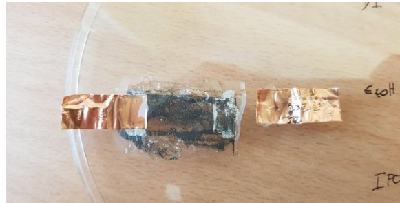
Εικόνα 6.9: Αισθητήρας b2g3s2 μετά το stretching 20%
