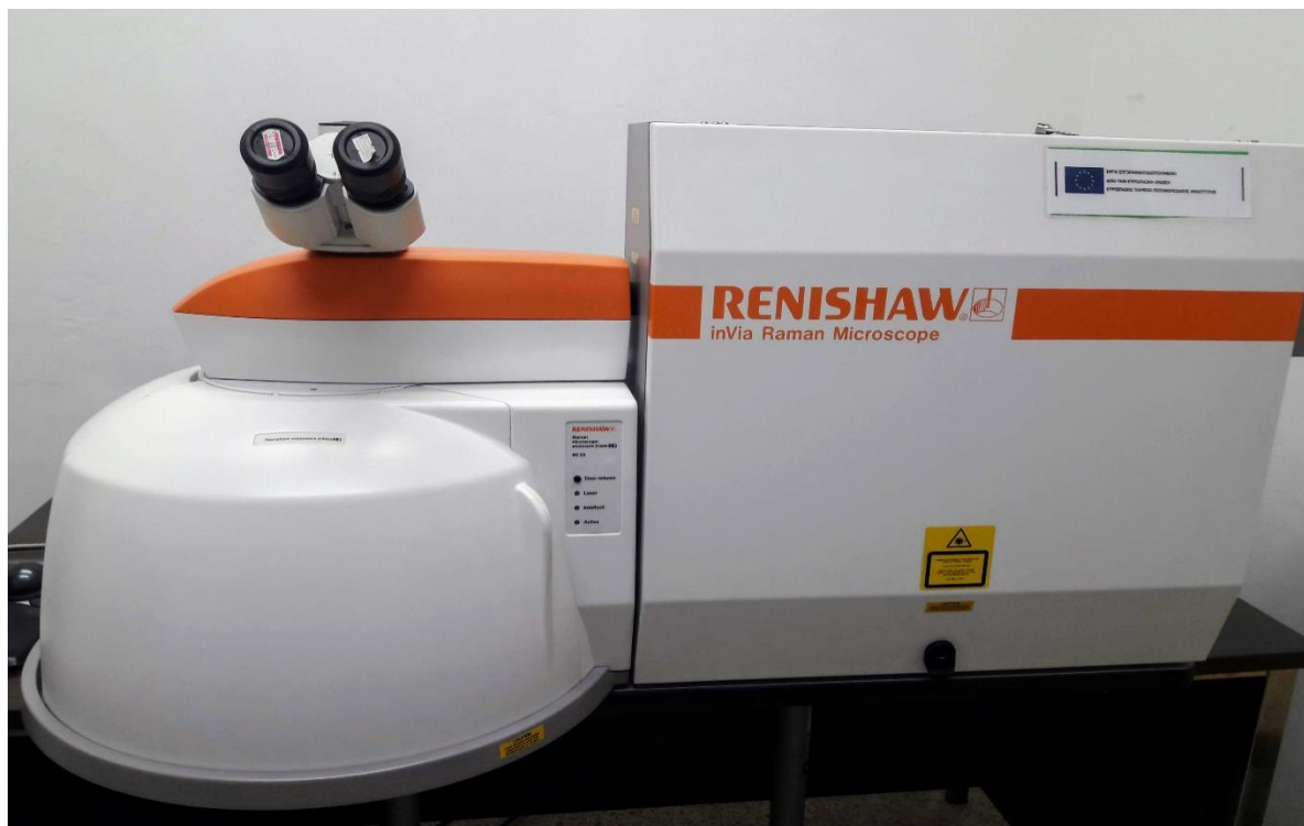
Σχήμα 29: Συσκευή microRaman τύπου RENISHAW inVia
