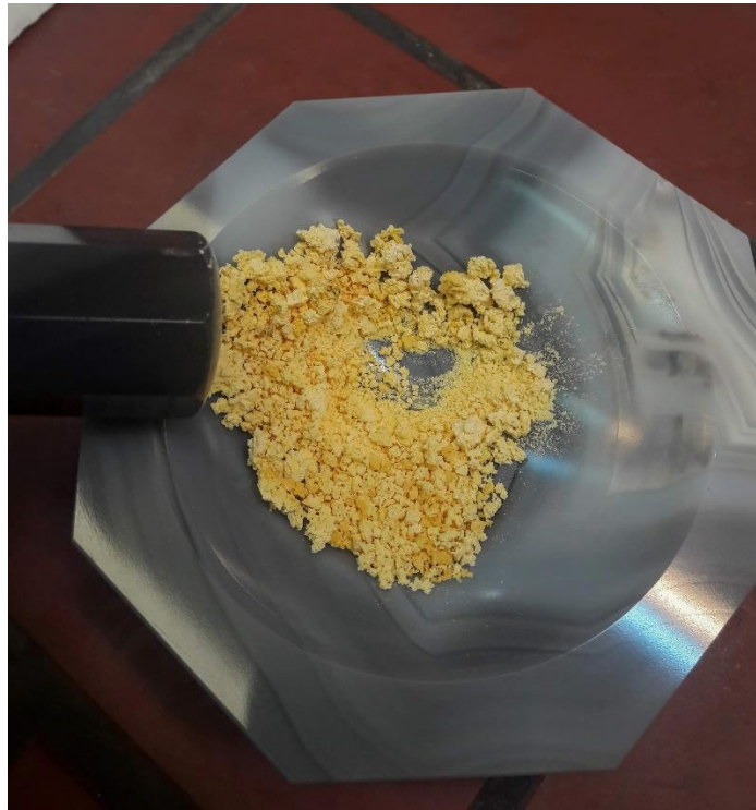
Σχήμα 21: Σκόνη N-doped TiO 2 πριν την λειοτρίβηση
