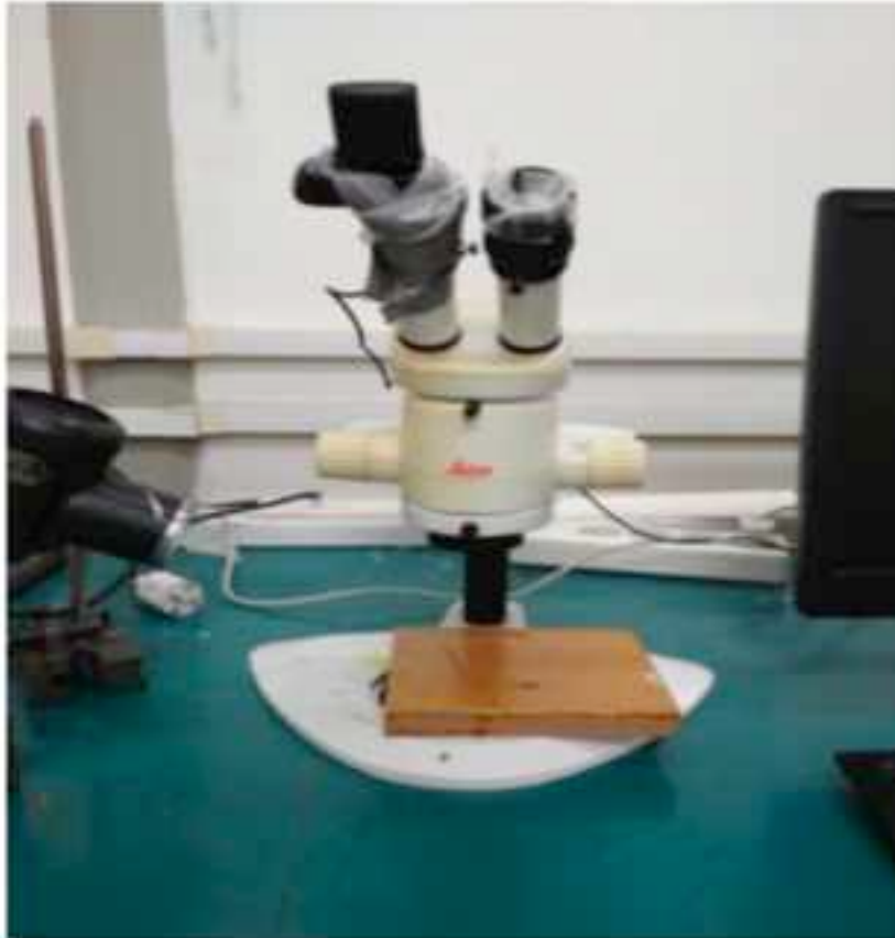
Εικόνα 3.9. Στερεοσκόπιο για λήψη φωτογραφιών του βάθους των αυλακιών.
