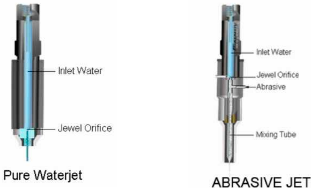
Εικόνα 1.2. Σύγκριση ακροφυσίων συμβατικής και αποξεστικής υδροκοπής [3].
