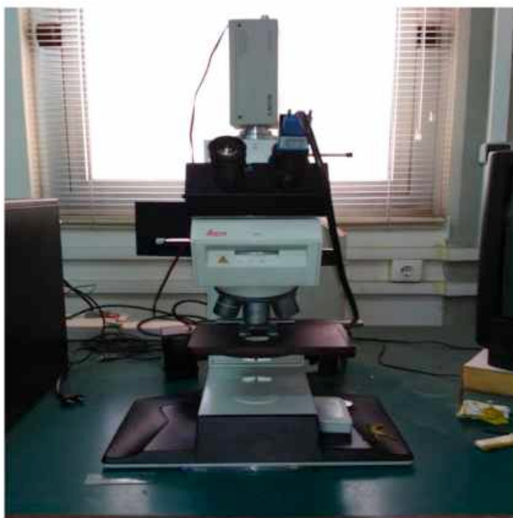
Εικόνα 3.8. Οπτικό μικροσκόπιο για λήψη φωτογραφιών του πλάτους των αυλακιών ( Δυνατότητα μεγέθυνσης 5x - 200x).
