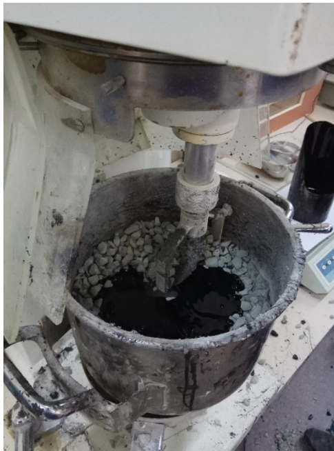
Εικόνα 6.7 Ανάδευση ασφάλτου στο μίγμα αδρανών
