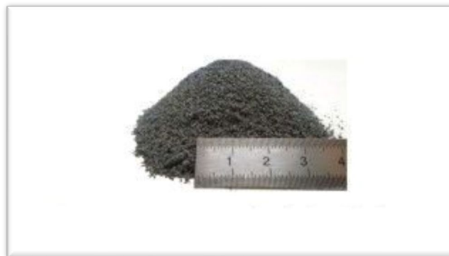
Εικόνα 5.6 Μέγεθος κόκκων του αντιδράμενου και ενεργοποιημένου ελαστικού
