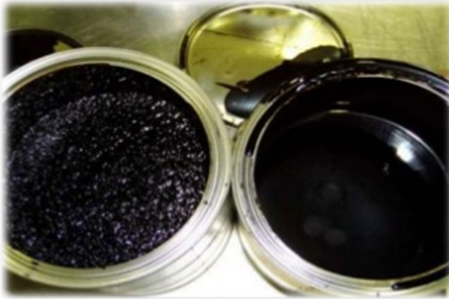
Εικόνα 3.15 Υγρή μέθοδος με υψηλό ιξώδες (αριστερά) & υγρή μέθοδος χωρίς ανάδευση (δεξιά)
