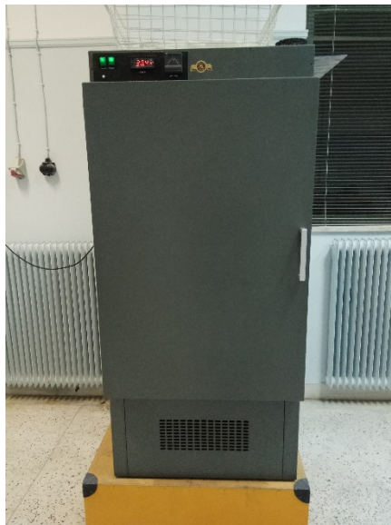
Εικόνα 6.21 Θερμοθάλαμος για την προθέρμανση των δοκιμίων στους 15°C, 20°C, 25°C και 30°C
