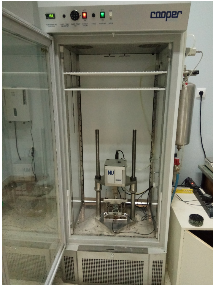
Εικόνα 6.18 Συσκευή Nottingham Asphalt Tester του Εργαστηρίου Οδοποιίας του ΕΜΠ
