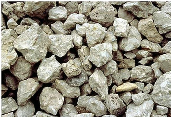
Εικόνα 2.4 Ανακυκλωμένα αδρανή σκυροδέματος
