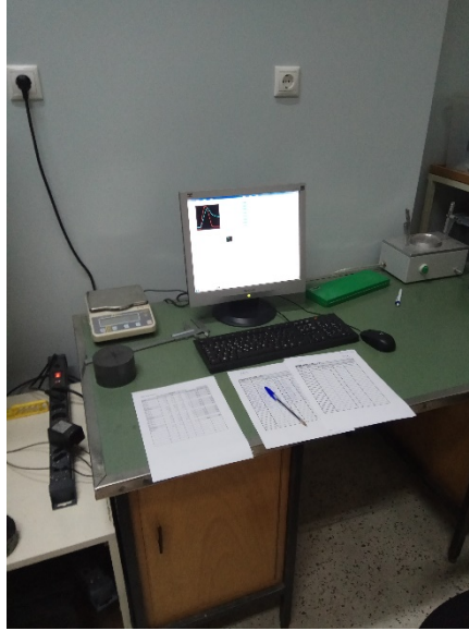
Εικόνα 6.20 Υπολογιστής συνδεδεμένος με την συσκευή NAT για την καταγραφή των μετρήσεων
