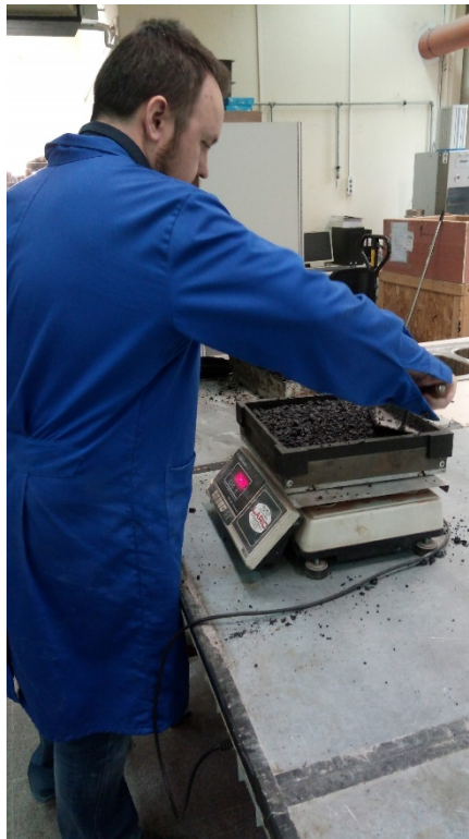
Εικόνα 6.11 Εισαγωγή ασφαλτομίγματος στην μήτρα
