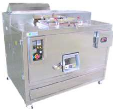
Σχήμα 4.2: Το ξηραντήριο GAIA GC-100.
