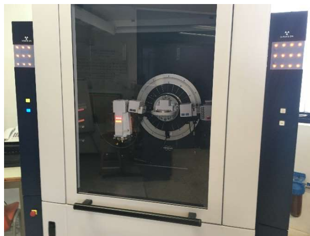
Σχήμα 4.9: Το περιθλασίμετρο X-ray diffraction)η XRD D8 Advance της Bruker
