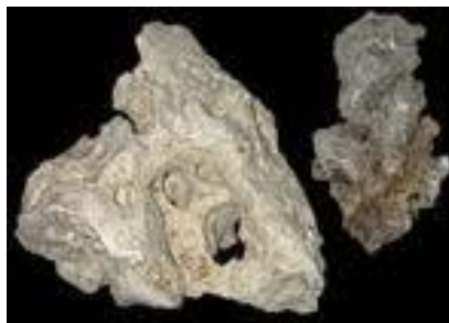
Σχήμα 2.17 Μορφή ρωγμάτωσης ισχνού ενέματος
