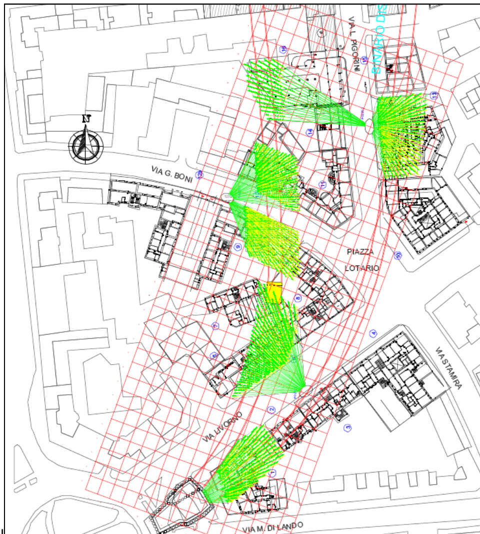
Σχήμα 5.9 Κάτοψη του σχεδίου ενεμάτωσης για την προστασία των κτιρίων στο πλαίσιο κατασκευής της νέας γραμμής μετρό B1 (Καταγραφή εταιρείας Keller κατά την εκτέλεση των εργασιών ενεμάτωσης)
