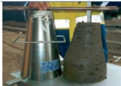
Σχήμα 3.17 Δοκιμή κάθισης για τον έλεγχο της καταλληλότητας του εισπιεζόμενου ενέματος (Ενημερωτικό φυλλάδιο της εταιρείας Keller)
