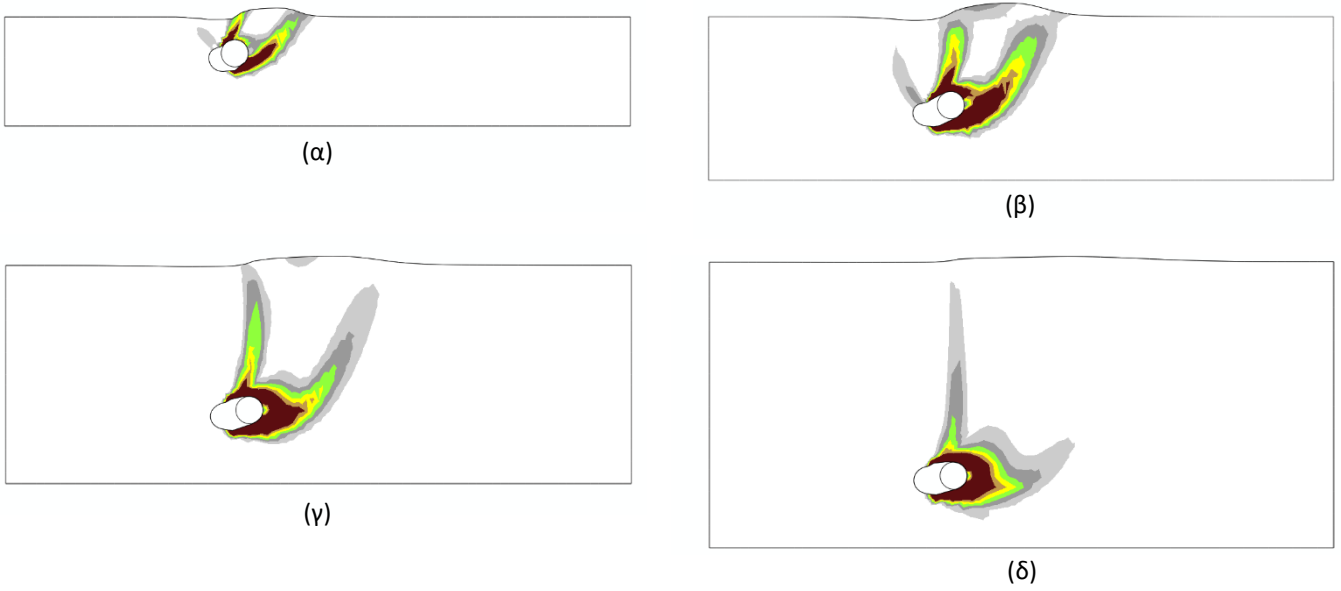
Σχήμα 3.4. Σύγκριση αριθμητικής μεθοδολογίας με αποτελέσματα πλευρικής μετατόπισης αγωγού (Trautmann and O'Rourke 1985) για άμμο με Dr = 45\% . Παραμορφωμένος κάρναβος με ισοΰψείς πλαστικών παραμορφώσεων (α) για H/D = 1.5 , (β) για H/D = 3.5 , (γ) για H/D = 5.5 και (δ) για H/D = 8 .
