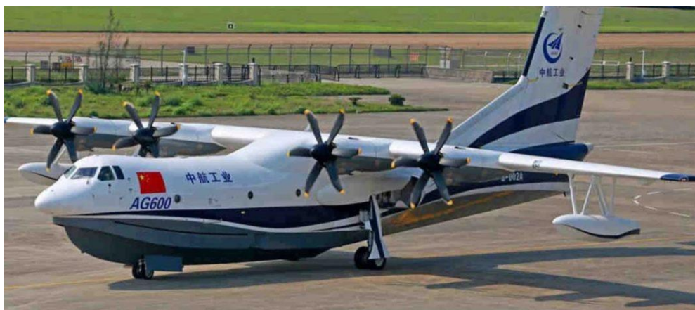
Εικόνα 1-3 Υδροπλάνο που συνδυάζει διαμόρφωση σκάφους με πλωτήρες
